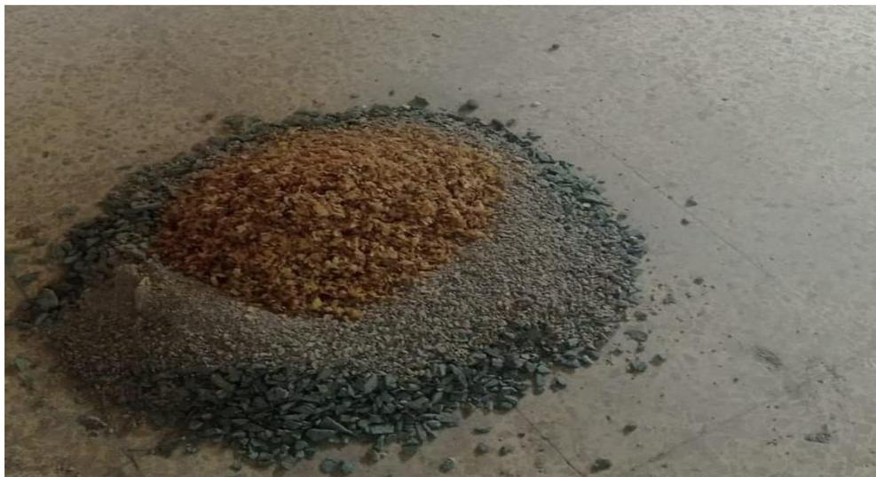
**Foto 9:** Mezcla del diseño con hoja de maíz
