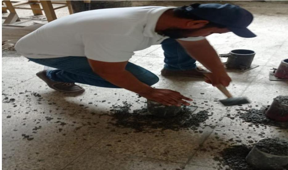
**Foto 10:** Elaboración de los cilindros de hormigón
