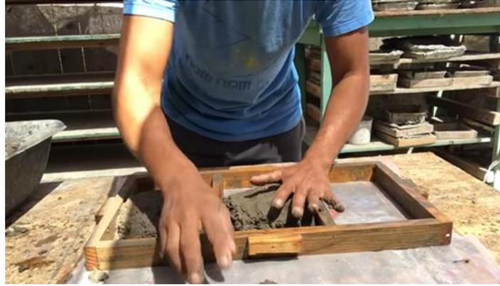
Figura 10 Elaboración manual de un adoquín
