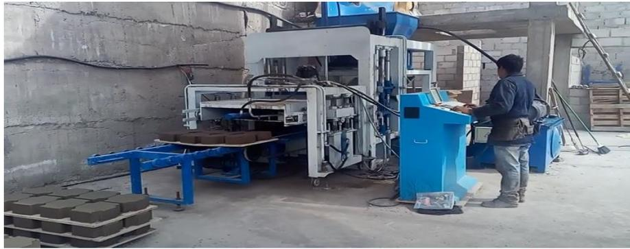
Figura 12 Elaboración automática de un adoquín
