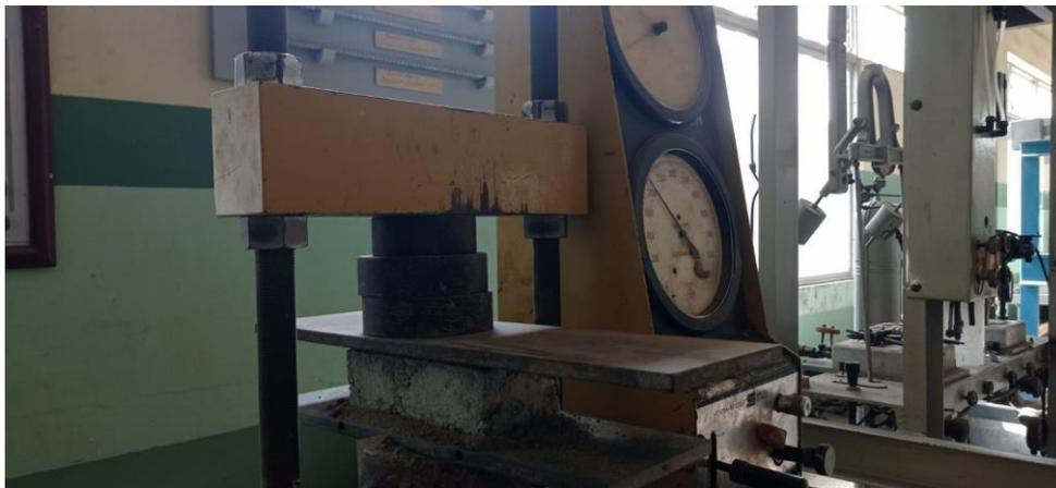
Figura 59 Ensayo C, B, R. a adoquín modificado al 10%.
