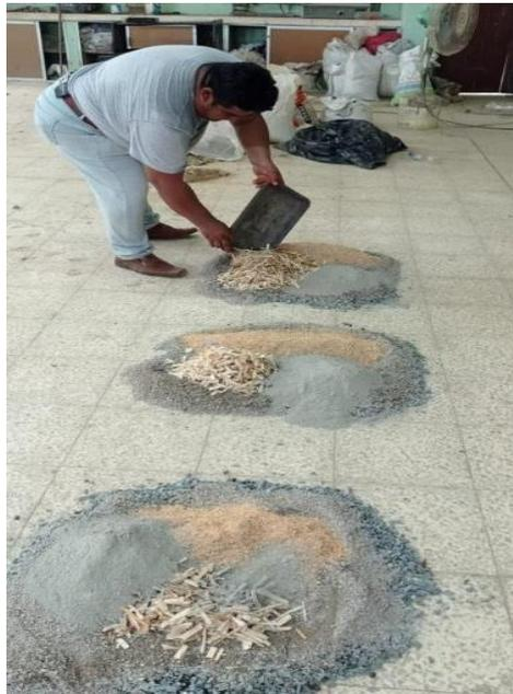
Figura 28 Colocación de agregados reciclados al 5%, 10%, 15%, de cascarilla de arroz, caña de azúcar, agregado grueso, cemento y arena listo para su proceso de mezclado.
