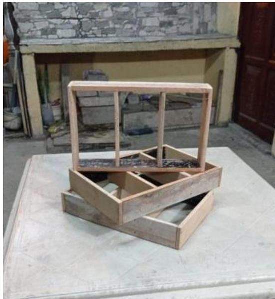
Figura 17 Moldes para el ensayo sus dimensiones son 20\*10\*6 cm<sup>2</sup>
