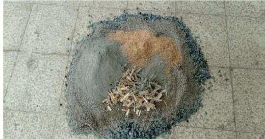
Figura 25 Colocación de agregados reciclados al 5%, de cascarilla de arroz, caña de azúcar, agregado grueso, cemento, arena.
