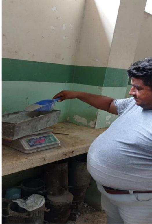
Figura 22 Pesado del agregado de cemento.
