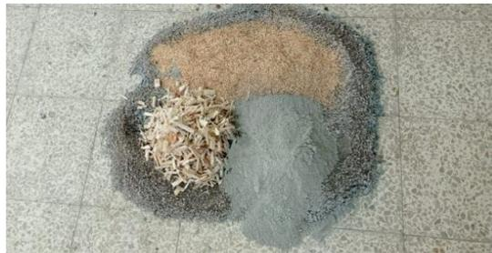
Figura 26 Colocación de agregados reciclados al 10%, de cascarilla de arroz, caña de azúcar, agregado grueso, cemento, arena.
