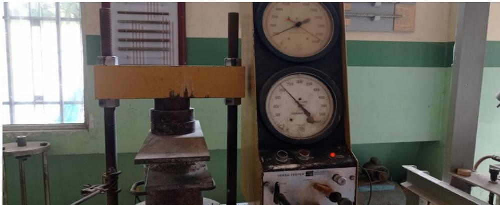
Figura 57 Ensayo de compresión de la muestra a los 28 días.
