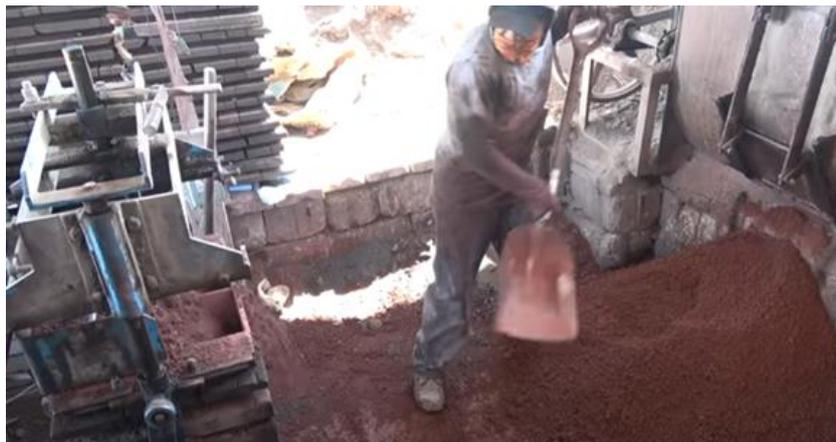
Figura 11 La elaboración semi-manual de un adoquín
