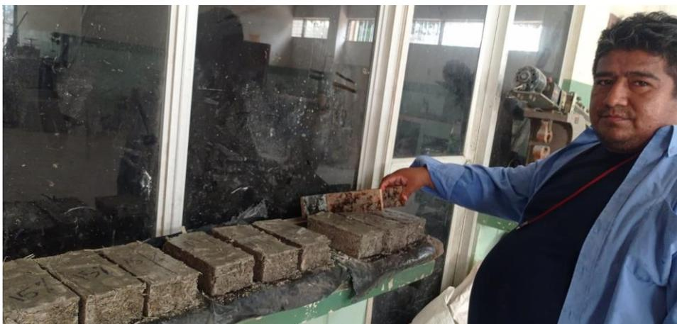
Figura 48 Desmolde de adoquín reciclado.
