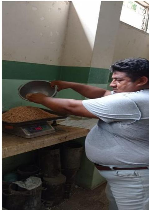
Figura 23 Pesado del agregado de cascarilla de arroz.
