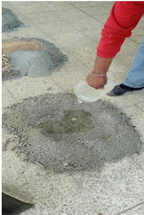
Figura 34 Porcentaje de agua para los agregados del ensayo al 5% .de 1600 c.c.
