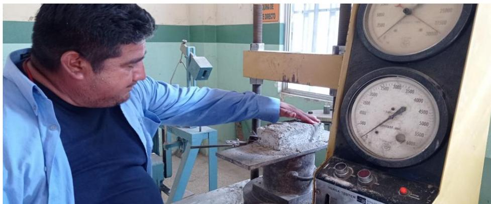
Figura 56 Ensayo de compresión de muestra a los 14 días.
