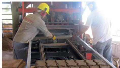
Figura 13 Forma de elaborar un adoquín
