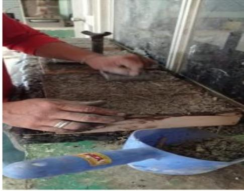
Figura 46 Tercer ensayo al 15%, presión de la muestra 3 y 1, para eliminación de partículas de aire.
