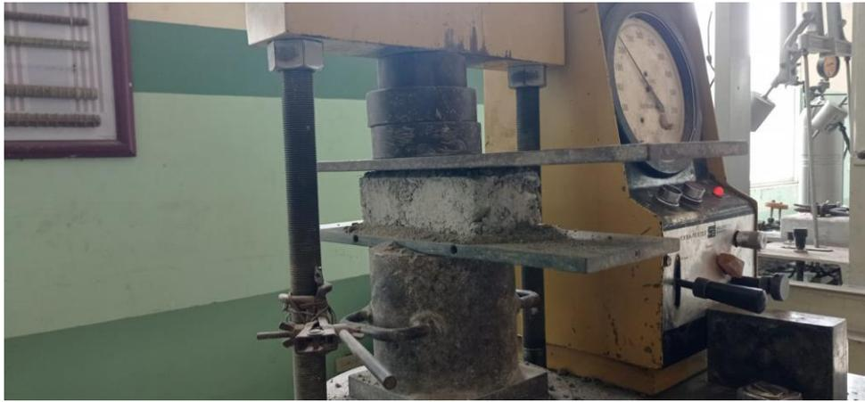
Figura 58 Prueba de ensayo C, B, R. a adoquín modificado al 5%
