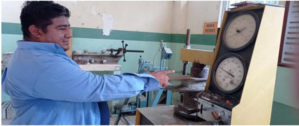
Figura 55 Ensayo de compresión de la muestra a los 7 días.
