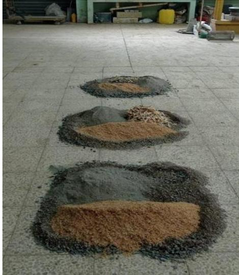
Figura 27 Colocación de agregados reciclados al 5%, 10%, 15%, de cascarilla de arroz, caña de azúcar, agregado grueso, cemento, arena.
