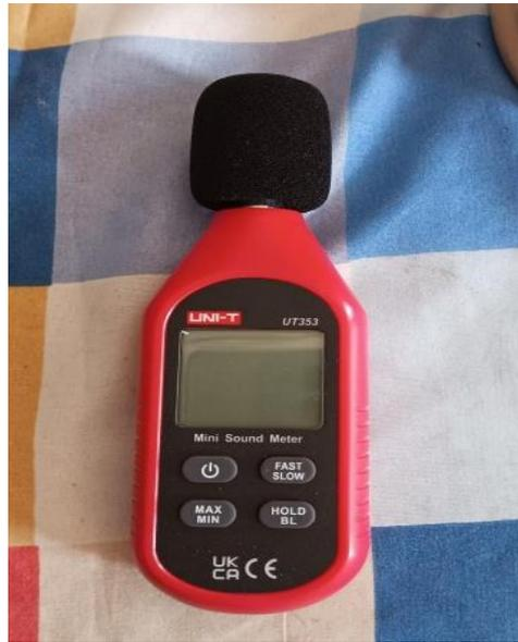
*Ilustración 19: Sonómetro UT353F*
