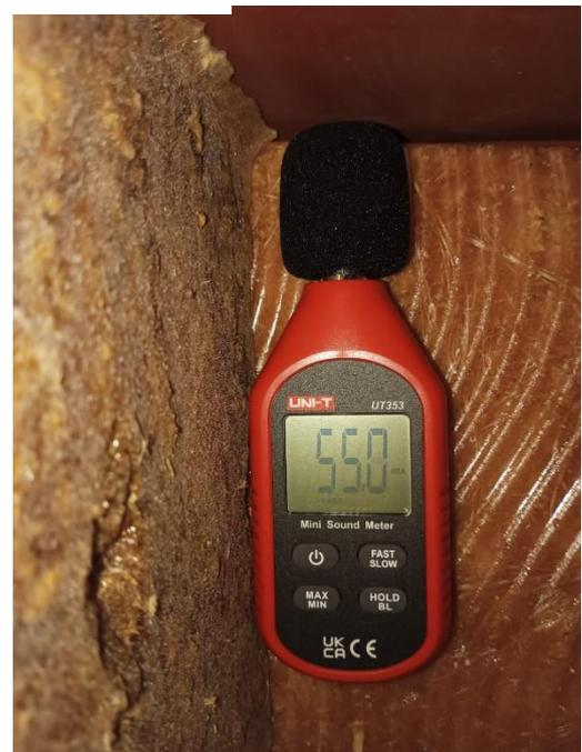
***Ilustración 16: Prueba de sonido con los paneles internos y la caja cerrada.***
