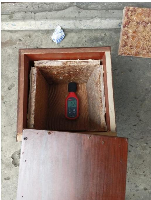
***Ilustración 17: Prueba con los paneles PDTY 03 introducidos en la caja.***
