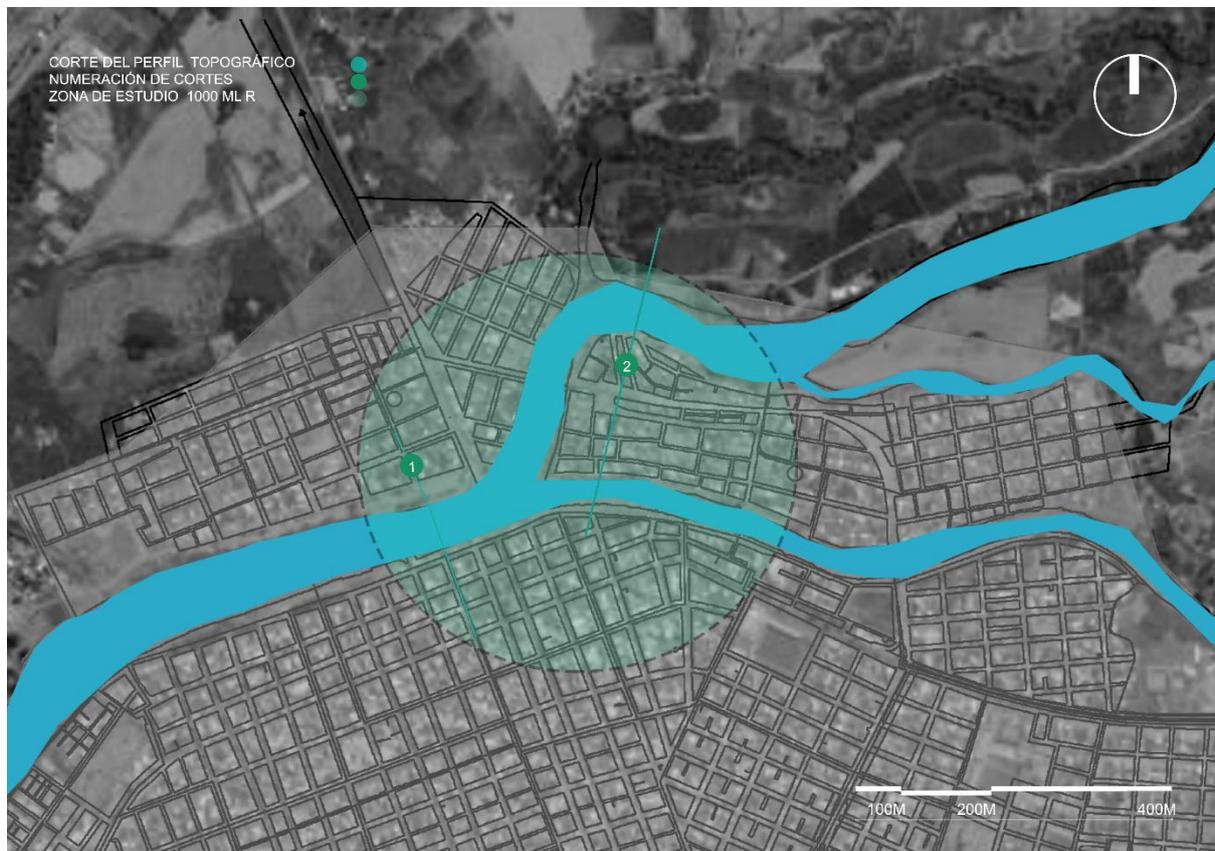
La primera sección presenta una distancia de recorrido de 1.08 KM, cotas de nivel máximas de 12m y cotas mínimas de 2m sobre el nivel del mar. Teniendo en la hidrología del río Babahoyo tiene una cota de 5 m, se puede decir que en esta sección presentan zonas inundables, debido a sus cotas bajas y que los límites del río que está compuesto por colinas, por ende, en cada invierno va a generar correntias.
