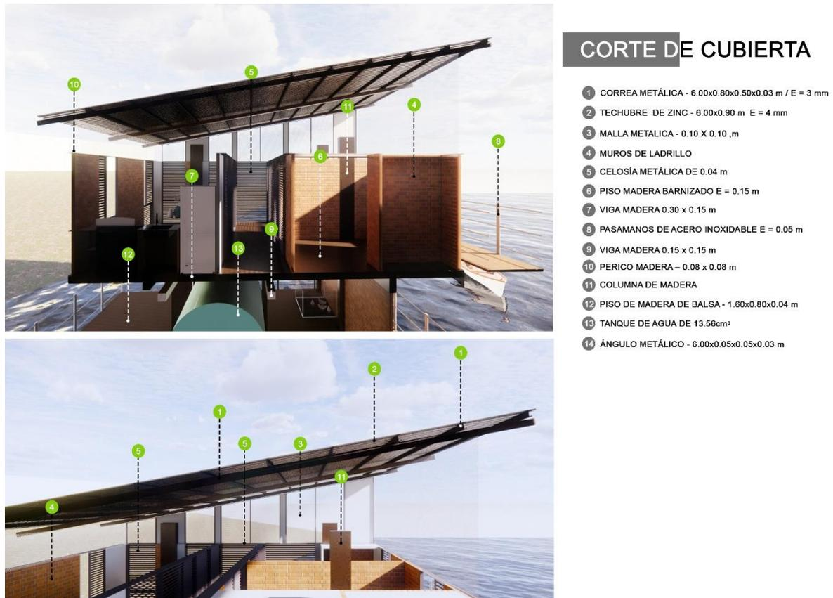
Ilustración 79. Corte esquemático de cubierta.
