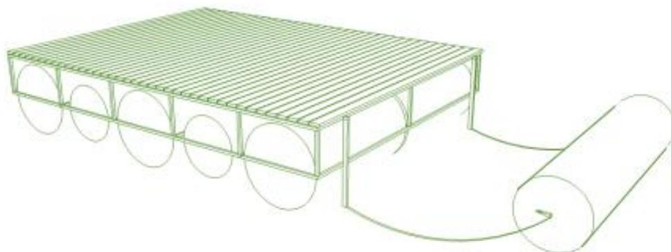
*Ilustración 67. Ejemplo de sistema de flotación con bidones.*
