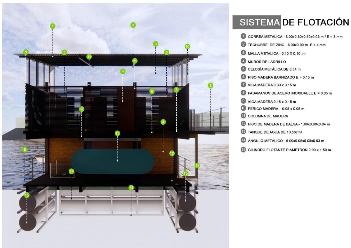
Ilustración 76. Sistema de flotación.
