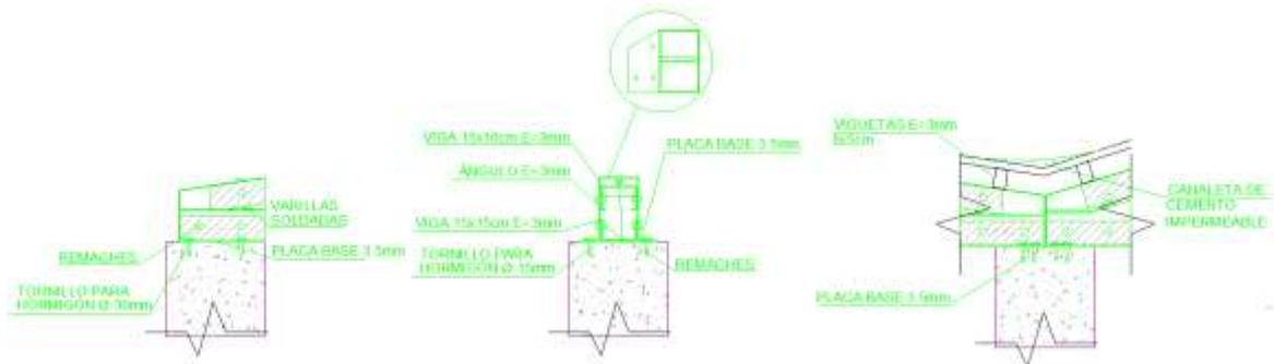
**Imagen 35:** Detalle de uniones: Viga- columna
