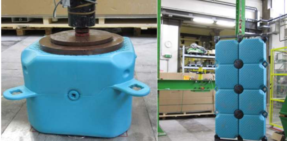
Imagen 19: Pruebas de resistencia en cubos de polietileno
