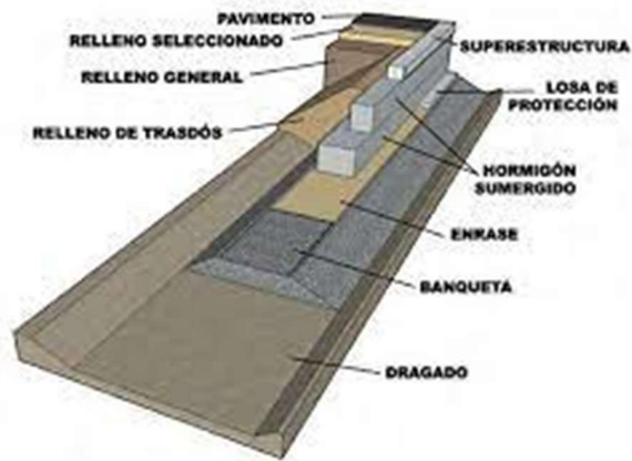
Imagen 14: Muelle de hormigón sumergidos
