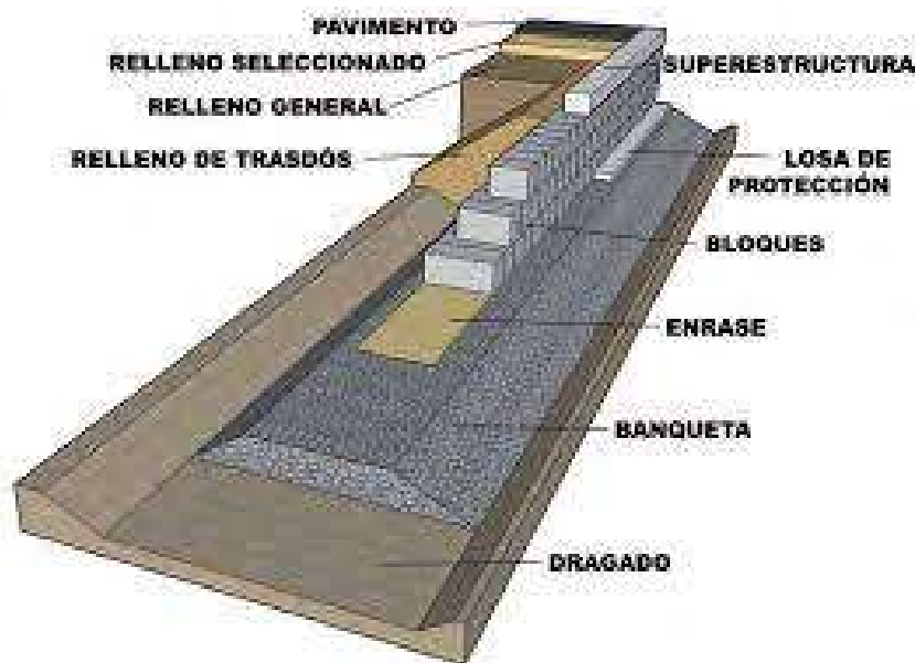
Imagen 13: Muelle de bloques prefabricados
