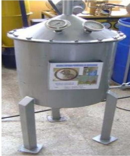
**Condensador o intercambiador de calor.**
