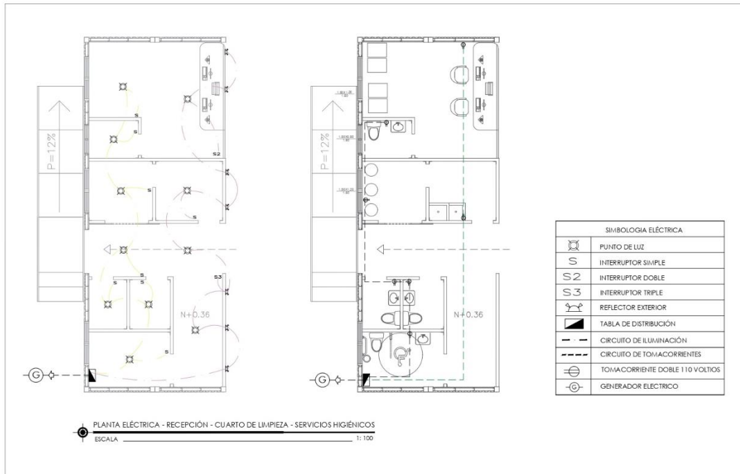
Figura 78. Planta eléctrica – Recepción – Cuarto de limpieza – SS.HH. Elaborado por: Mejía, L. y Trejo, C. (2022).
