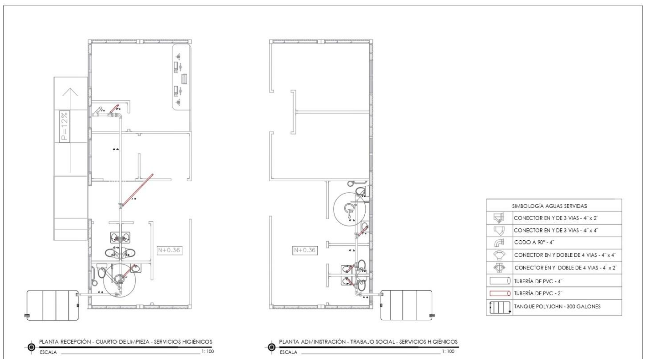
Figura 85. Detalle Sistema de aguas servidas. Elaborado por: Mejía, L. y Trejo, C. (2022).
