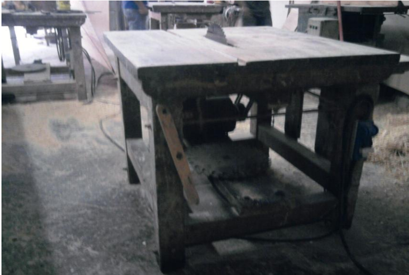
SIERRA CIRCULAR (actual) MOTOR MARCA: KOLBACH 3 HP 1750 RPM 220 VOLTIOS
