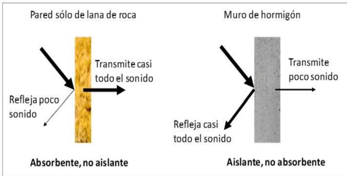
Ilustración 15: Aislamiento acústico en paredes.
