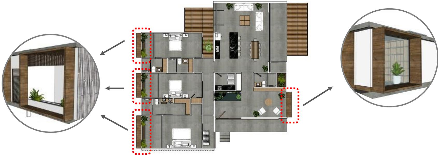
Figura 31: Control de protección solar.
