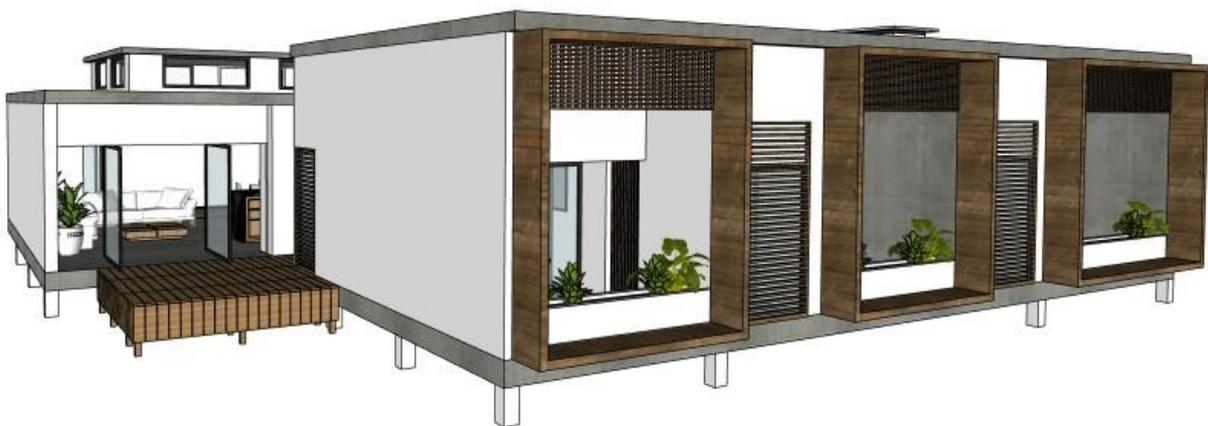
Figura 39: sistema constructivo Palafito.
