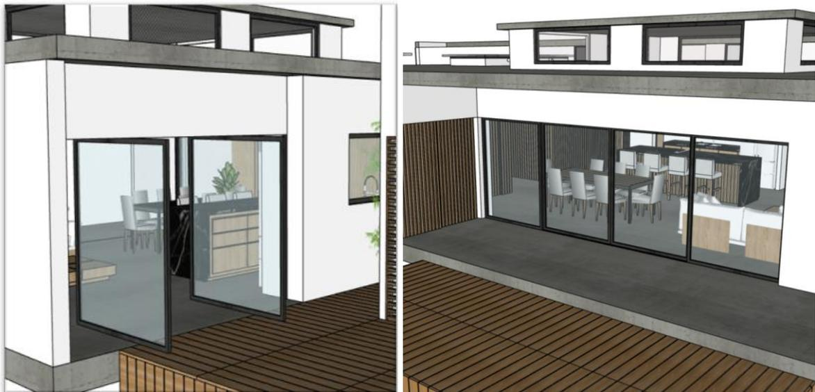
Figura 46: Ventanas pivotantes y corredizas.
