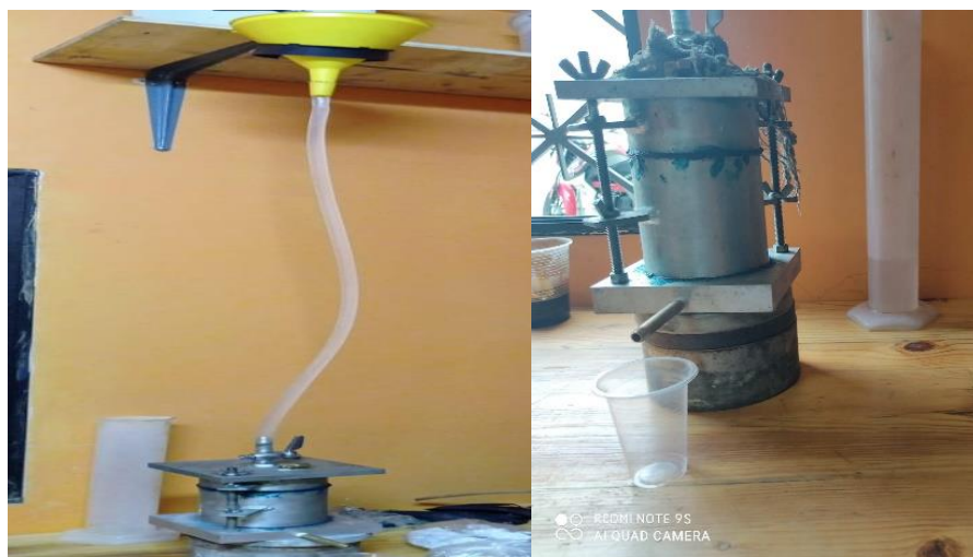
Nota: Armado del cilindro Figura 37: Aplicación de agua constante sobre la mezcla Elaborado por: (Tarira, D. y Velarde, G. 2022).
