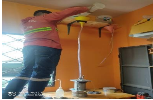
Nota: Equipo de permeabilidad Figura 26: Equipo de permeabilidad Elaborado por: (Tarira, D. y Velarde, G. 2022).
