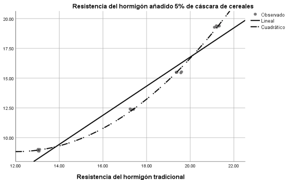
Figura 16: Ajuste de curvas para modelos de regresión para resistencia del hormigón
