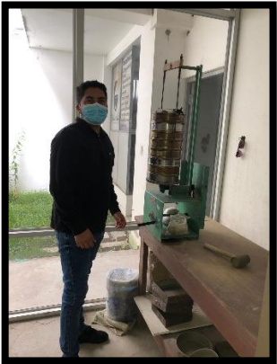
Ilustración 4: Tamices de acuerdo con la norma ASTM C-696
