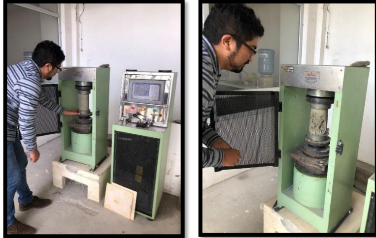
Ilustración 7: Determinación de la resistencia a compresión NTE INEN 1573 ASTM C – 39
