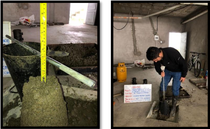
Ilustración 5: Probetas de hormigón NTE INEN 1576
