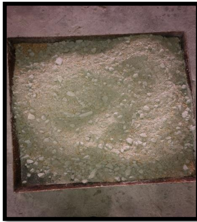
Ilustración 10: Dosificación con el 10% de cáscara de cereales
