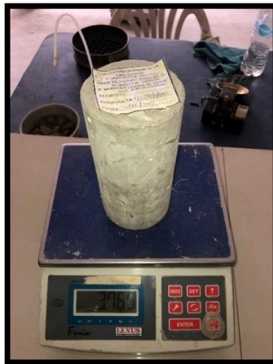
Ilustración 13: Pesaje de cilindros modificados y tradicionales
