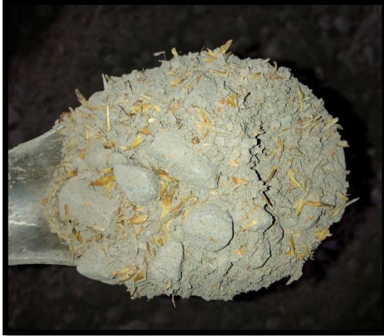
Ilustración 12: Hormigón mezclado con cáscara de trigo y cebada
