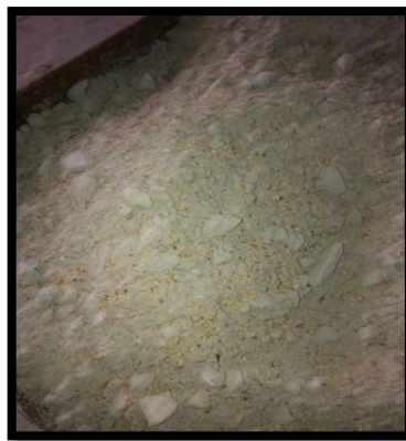
Ilustración 11: Dosificación con el 15% de cáscara de cereales
