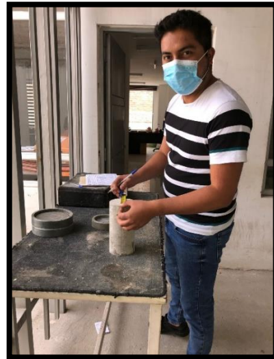
Ilustración 13: Pesaje de cilindros modificados y tradicionales
