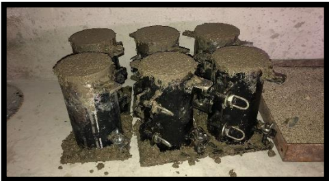
Ilustración 5: Probetas de hormigón NTE INEN 1576
