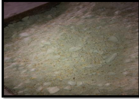
Ilustración 9: Dosificación con el 5% de cáscara de cereales
