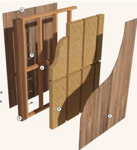
*Figura 37. Detalle constructivo de muro de madera tipo panel en axonometría.
