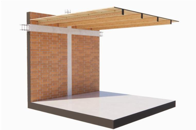
*Figura 42. Detalle constructivo de muro y estructura confinadas con vista en perspectiva.
