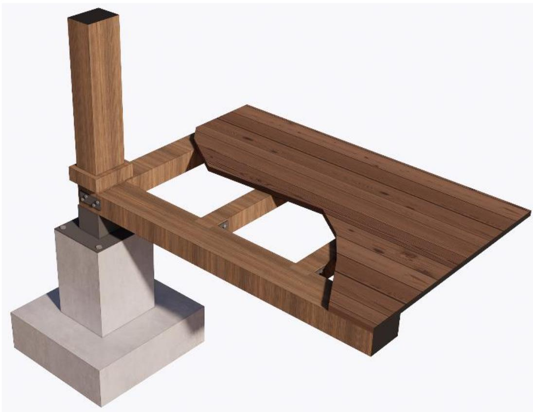
*Figura 34. Detalle constructivo de cimentación, estructura y piso en perspectiva.
