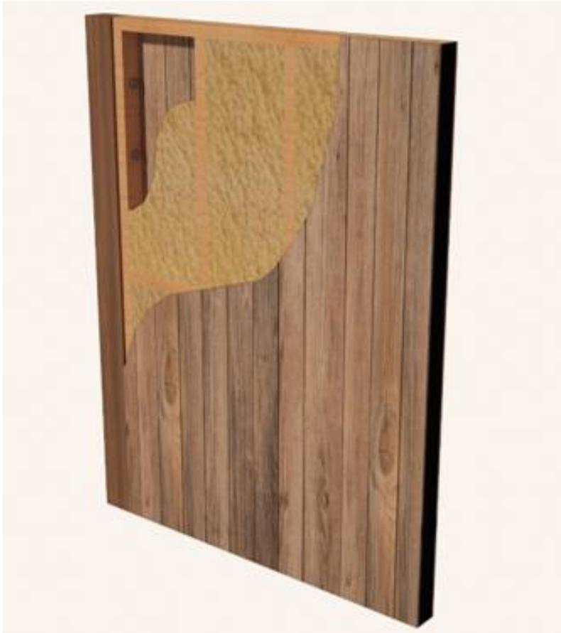
**Figura 38.** Detalle constructivo de muro de madera tipo panel en perspectiva.
