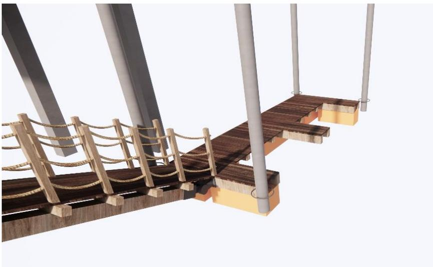
*Figura 44. Detalle constructivo de plataforma de muelle flotante en perspectiva.
