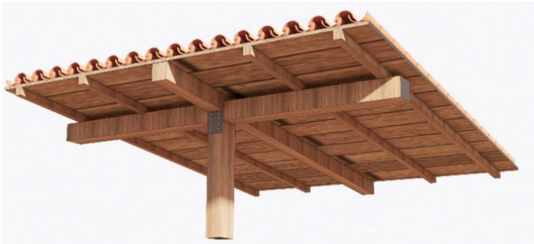
*Figura 36. Detalle constructivo de cubierta en perspectiva.
