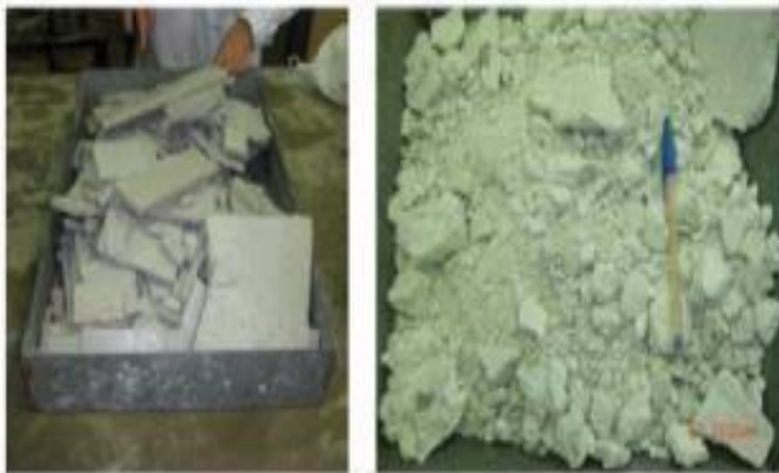
Figura 19. Yeso recuperado de placas utilizadas en construcción Elaborado por: Álvarez, C. (2022).
