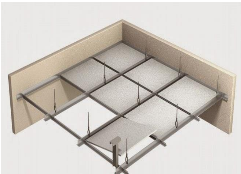
Figura 36. Instalación panel de yeso al tumbado Elaborado por: Álvarez, C. (2022)
