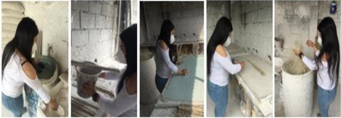
Figura 33. Elaboración de panel acústico y térmico con materiales reciclados Elaborado por: Álvarez, C. (2022)
