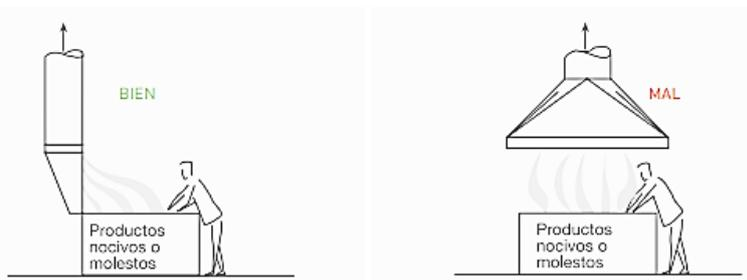
**Figura 14.** Comparación entre dos puntos de aspiración con respecto a las vías respiratorias.
