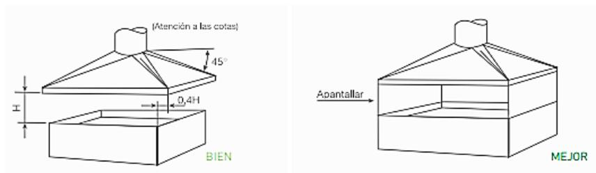
**Figura 13.** Comparación entre menor y mayor encerramiento de una fuente de contaminación.
