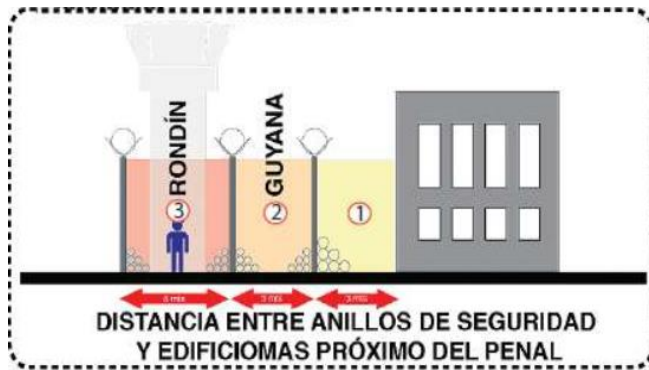
Figura 15: Anillos de Seguridad
