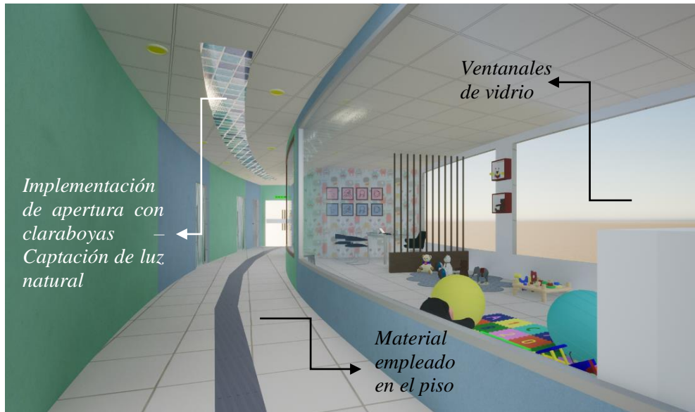
Figura 51. Apertura de techo en pasillo para ingreso de luz y variación térmica
