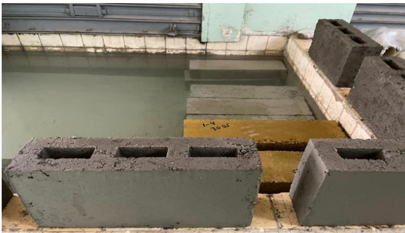
**Figura 27:** Curado de bloques con adición de concha de coco
