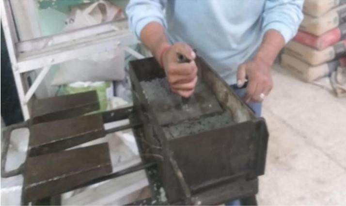
**Figura 15:** Colado de hormigón en bloquera
