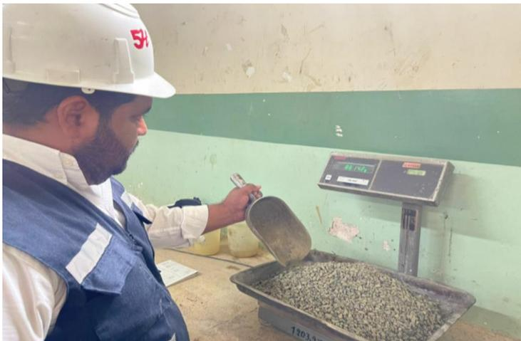
**Figura 12:** Dosificación de agregado grueso (piedra triturada 3/8´´) para bloque de hormigón sin adición de concha de coco
