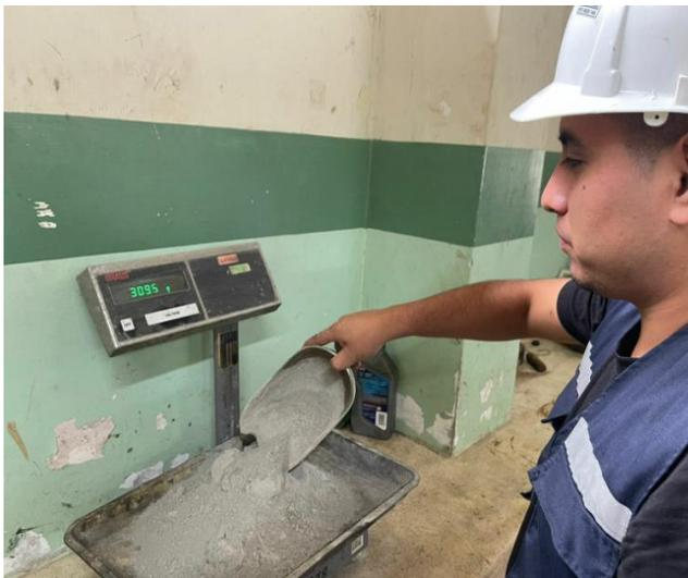
**Figura 21:** Dosificación de cemento para bloque de hormigón con adición de concha de coco.
