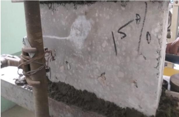
**Figura 49:** Falla en prototipo de bloque con adición al 15% de concha de coco
