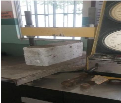
**Figura 41:** Colocación de prototipo de bloque sobre prensa hidráulica
