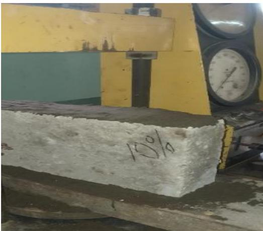
**Figura 44:** Prototipo de bloque con adición del 10% de concha de coco
