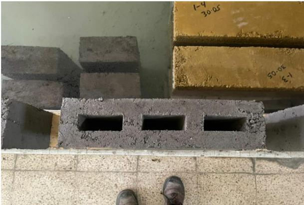
**Figura 18:** Bloques sumergidos en agua para curado
