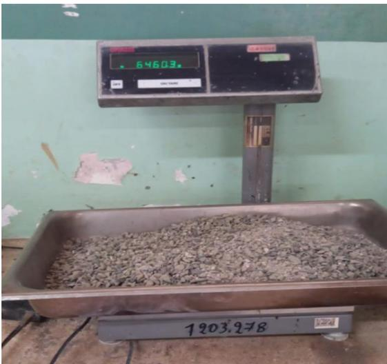
**Figura 35:** Peso del agregado grueso (piedra triturada) menos el 25% según diseño.
