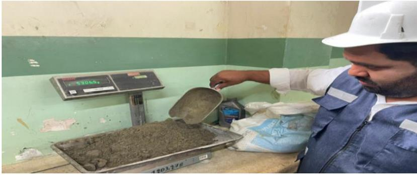
**Figura 11:** dosificación de agregado fino (arena) para bloque de hormigón sin adición de concha de coco.
