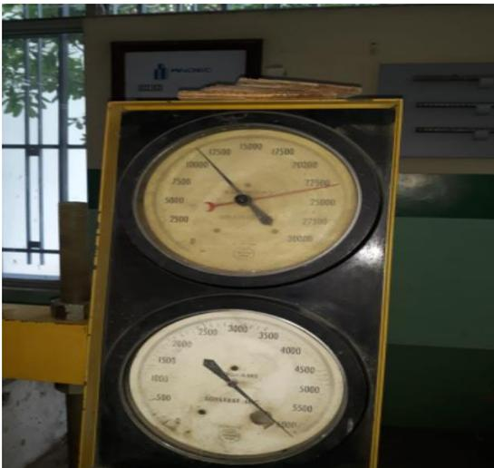
**Figura 53:** Valor de ensayo por rotura de prototipo de bloque al 25% de adición de concha de coco.
