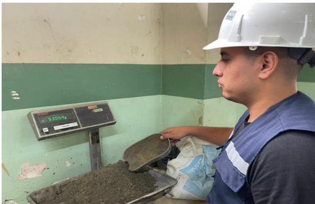
**Figura 19:** Dosificación de agregado fino (arena) para bloque de hormigón con adición de concha de coco.
