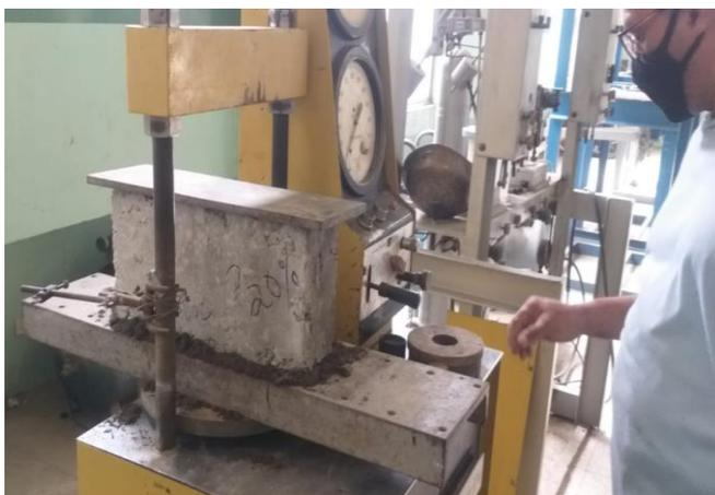
**Figura 50:** Prototipo de bloque con adición del 20% de concha de coco
