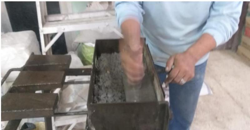
**Figura 26:** Fabricación de bloque de hormigón con adición de concha de coco
