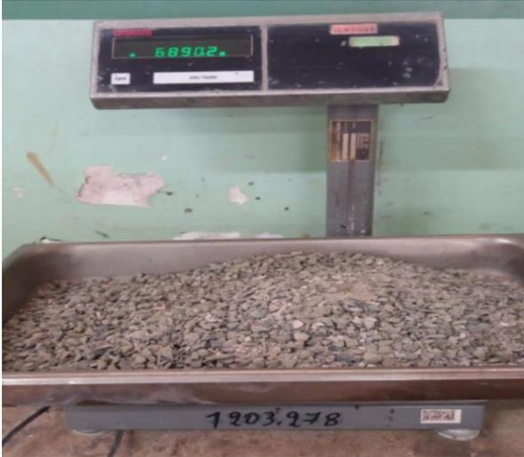
**Figura 33:** Peso del agregado grueso (piedra triturada) menos el 20% según diseño
