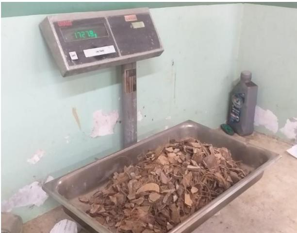
**Figura 34:** Peso del agregado grueso (piedra triturada) menos el 20% según diseño
