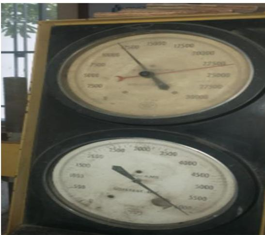
**Figura 48:** Valor de ensayo por rotura de prototipo de bloque al 15% de adición de concha de coco
