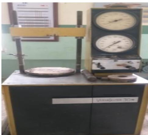
**Figura 10:** Prensa hidráulica para medir resistencia (VERSATESTER 30M)
