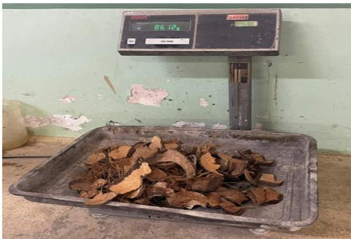
**Figura 30:** Peso de la concha de coco en valor correspondiente al 10% del agregado grueso
