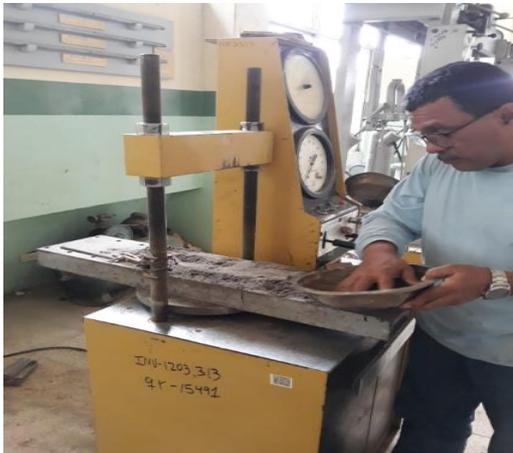
**Figura 38:** Preparación de prensa hidráulica para ensayo a compresión
