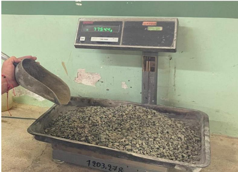
**Figura 29:** Peso del agregado grueso (piedra triturada) menos el 10% según diseño.
