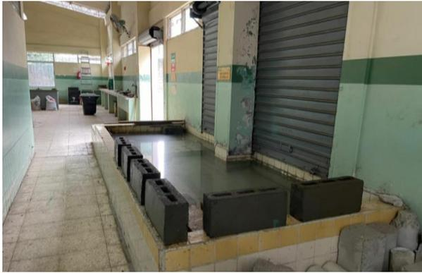
**Figura 17:** Bloques recién fabricado
