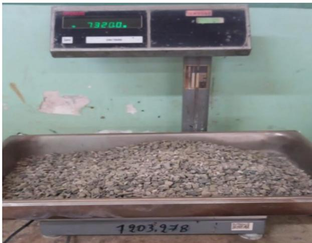
**Figura 31:** Peso del agregado grueso (piedra triturada) menos el 15% según diseño
