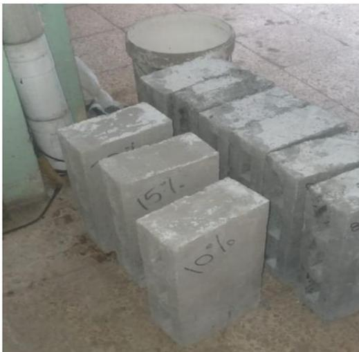
**Figura 37:** Prototipos de bloques por porcentaje de adición de concha de coco para ensayar
