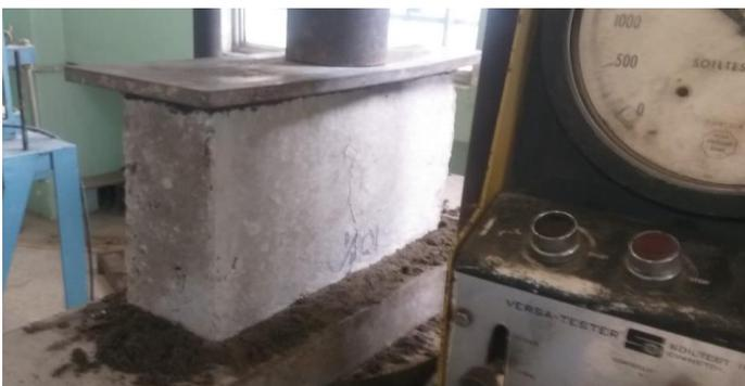
**Figura 46:** Falla en prototipo de bloque con adición al 10% de concha de coco
