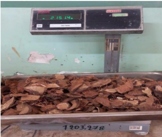
**Figura 36:** *Peso* del agregado grueso (piedra triturada) menos el 25% según diseño
