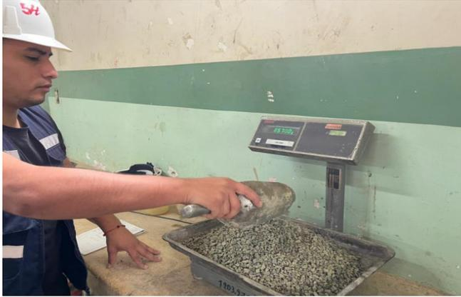
**Figura 20:** Dosificación de agregado grueso (piedra triturada 3/8´´) para bloque de hormigón con adición de concha de coco.
