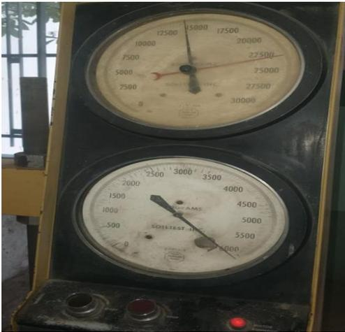
**Figura 51:** Valor de ensayo por rotura de prototipo de bloque al 20% de adición de concha de coco
