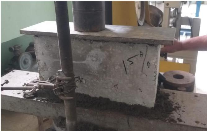
**Figura 47:** Prototipo de bloque con adición del 15% de concha de coco.
