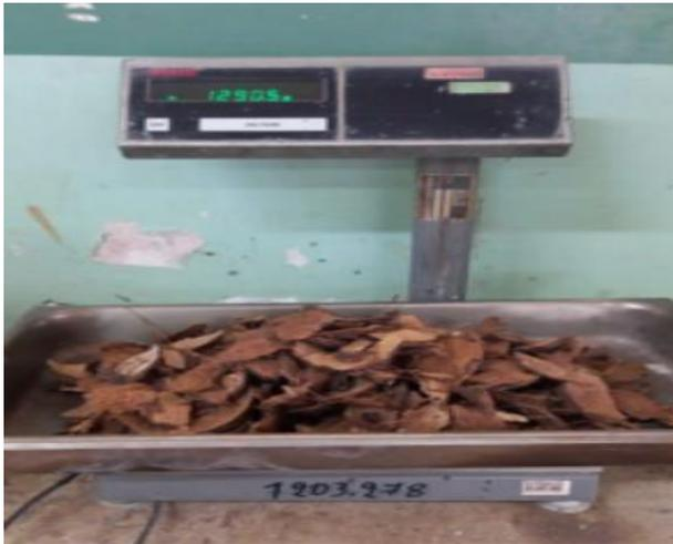
**Figura 32:** Peso de la concha de coco en valor correspondiente al 15% del agregado grueso.
