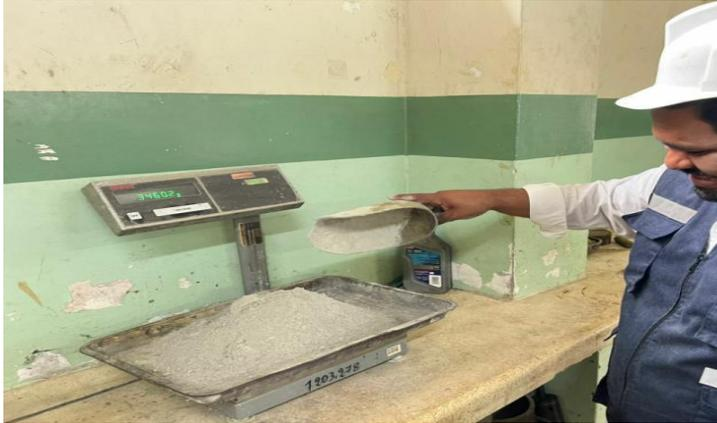
**Figura 13:** Dosificación de cemento para bloque de hormigón sin adición de concha de coco
