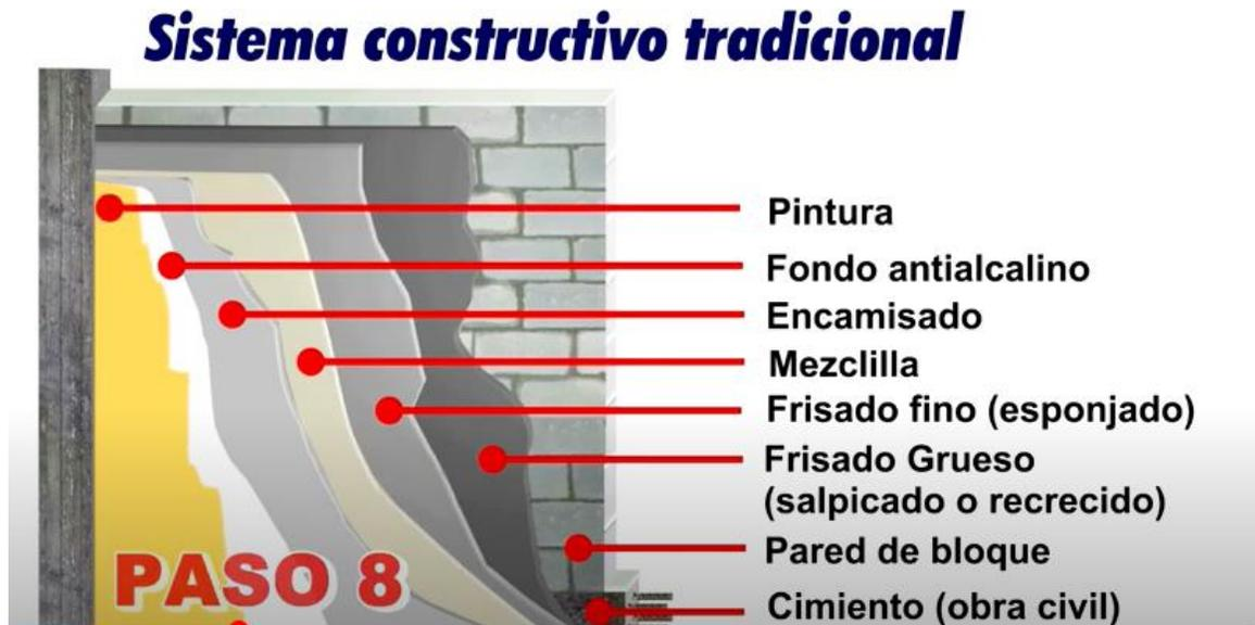
*Ilustración 1 Proceso constructivo del sistema constructivo tradicional*
