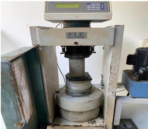
**Figura 19.-** Prueba de compresión en la máquina universal de la respectiva muestra de hormigón con ceniza volcánica y fibra de vidrio.
