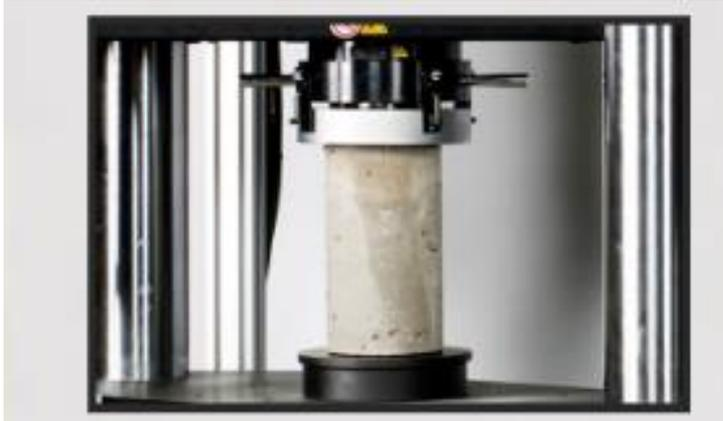
**Figura 5.-** Resistencia a compresión
