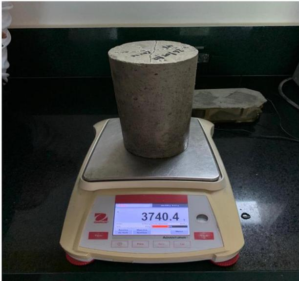
**Figura 18.-** Masa de la respectiva muestra de hormigón con ceniza volcánica y fibra de vidrio.
