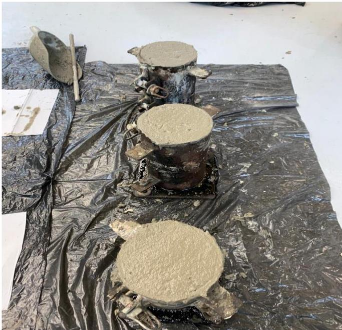
**Figura 17.-** Muestras preparadas de hormigón con ceniza volcánica y fibra de vidrio.
