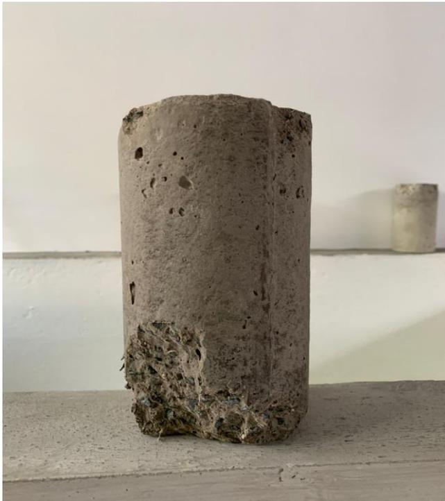
**Figura 20.-** Rotura de la respectiva muestra de hormigón con ceniza volcánica y fibra de vidrio.
