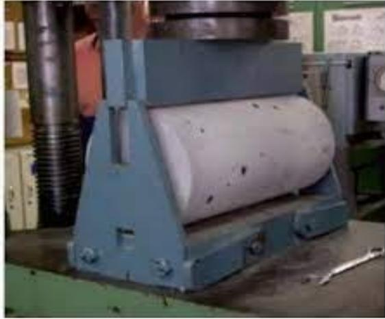
**Nota:** Ensayos a tracción del hormigón.
