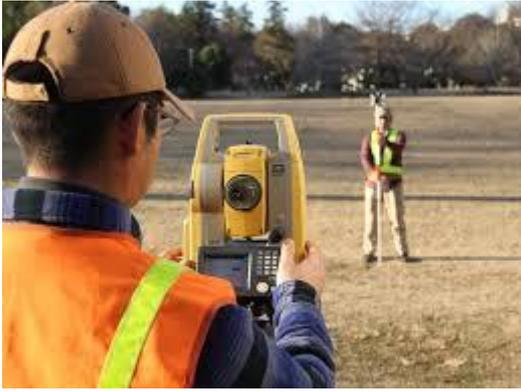
**Figura 3:** Rubro Trazado y replanteo con equipos topográficos
