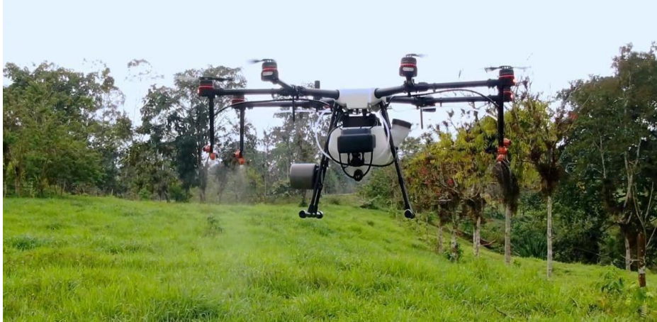
FIGURA 13 DRONES DJI DE 8 BOQUILLAS Elaboración: Freire y Martínez (2022)
