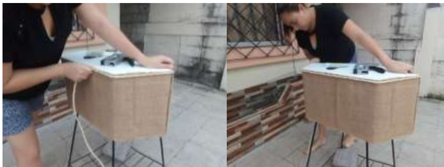
Figura 24. Tapizado del bloque de cubetas de huevo con yute
