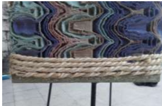
Figura 23. Forrado del borde del bloque de cubetas de huevo con cabuya
