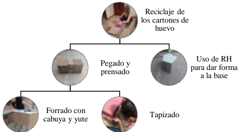
Figura 14. Flujograma del proceso previo para la elaboración del mobiliario
