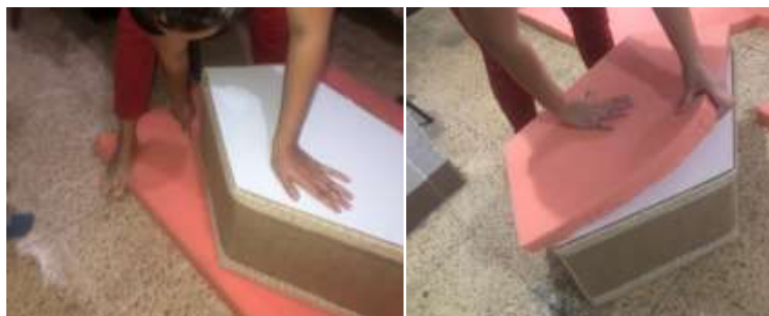
Figura 25. Cortado y colocación de la esponja para el asiento del puff
