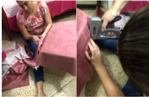
Figura 26. Tapizado del asiento del puff
