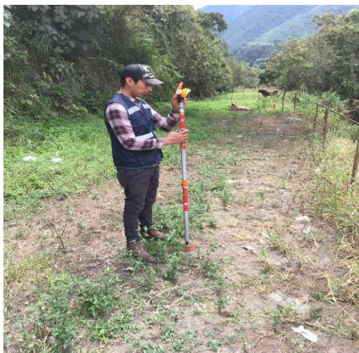
Figura 5. Mediciones con el prisma Elaborado por: Buñay, J. (2022)
