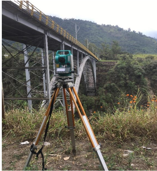
Figura 4. Instalación Estación Total Elaborado por: Buñay, J. (2022)
