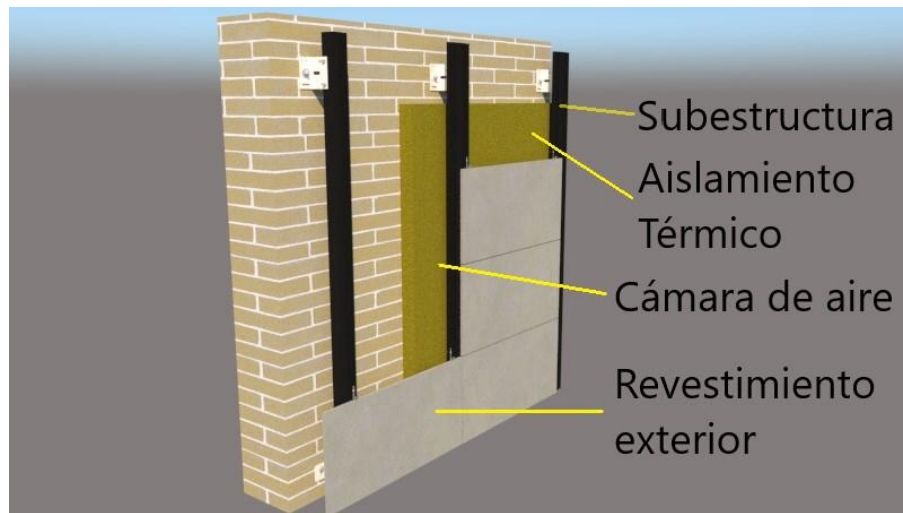
Imagen 54. Detalle fachada ventilada Elaborado por: Villavicencio, S. (2022)
