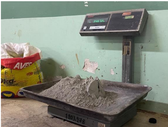
Figura 17. Peso de materiales para elaboración de bloque (cemento).
