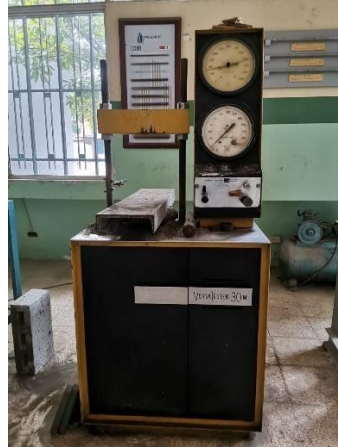
Figura 24. Equipo para prueba de compresión Versatester 30M. Elaborado por: Heras, G. y Paredes, C. (2022).
