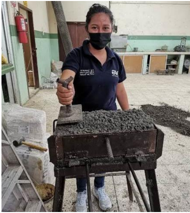
Figura 21. Bloque elaborado en molde de acero.
