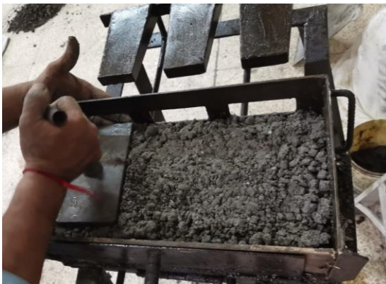
Figura 20. Materiales mezclados para elaboración de bloque con ceniza de cáscara de maní, concha de manglar triturada, cemento, piedra chispa y agua (bloque elaborado en molde de acero).
