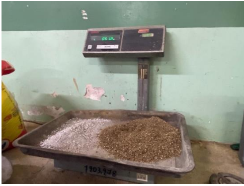
Figura 16. Peso de materiales para elaboración de bloque (ceniza cáscara de maní y concha de manglar triturada).
