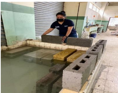
Figura 23. Curado de bloque elaborado en laboratorio Arnaldo Ruffini (Universidad Estatal de Guayaquil).
