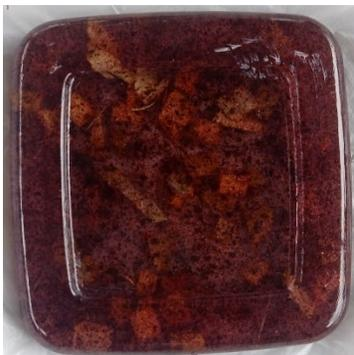
**Figura 52.** Prototipo después de exponerse a blanqueadores y detergentes.
