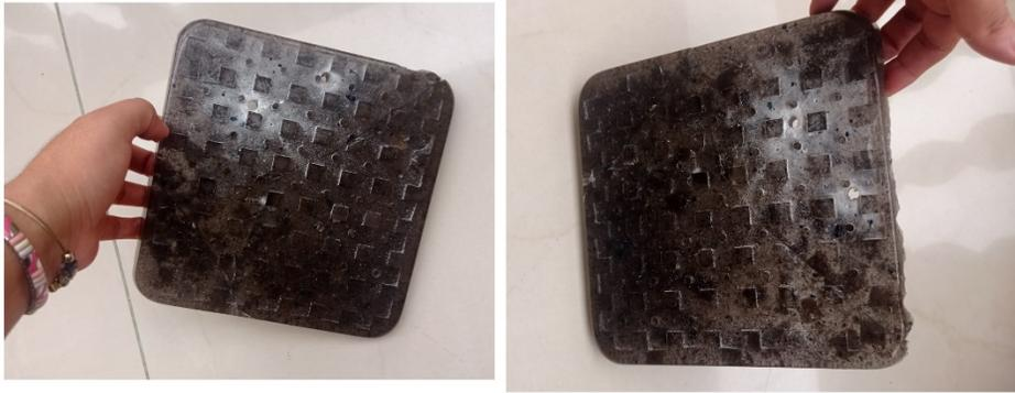
**Figura 50.** Panel expuesto a un peso de 1.160KG
