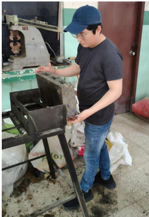
Foto 42: Retiro del bloque del molde. Elaborado por: Lara, R. y Mejía, N. (2022)
