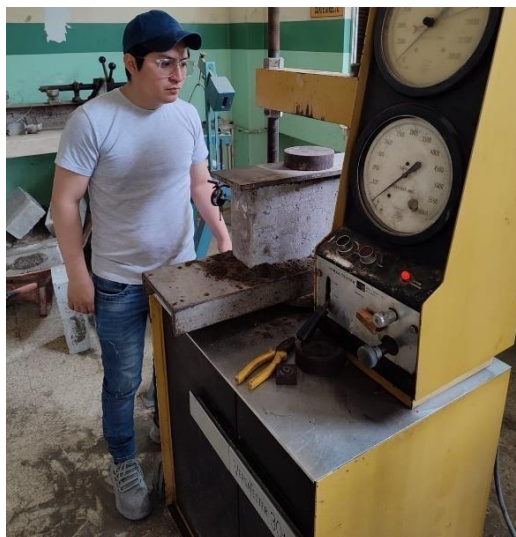
Foto 48: Ensayo a compresión Elaborado por: Lara, R. y Mejía, N. (2022)
