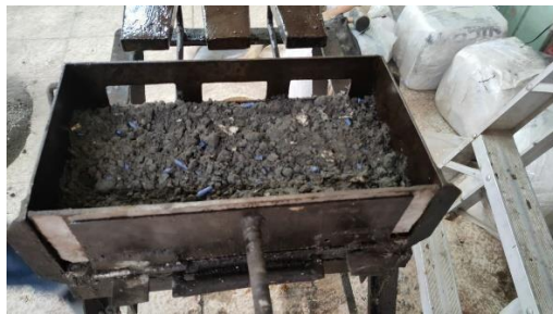
Foto 35: Agregando mezcla al molde. Elaborado por: Lara, R. y Mejía, N. (2022)
