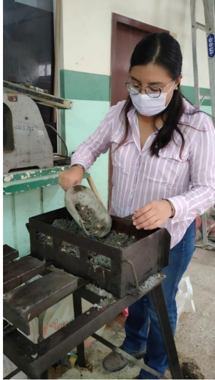
Foto 34: Agregando mezcla al molde. Elaborado por: Lara, R. y Mejía, N. (2022)
