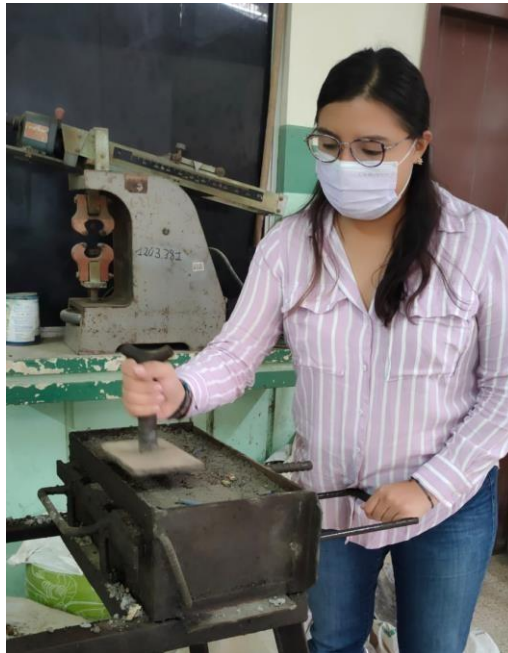
Foto 40. Molde compactado. Elaborado por: Lara, R. y Mejía, N. (2022)
