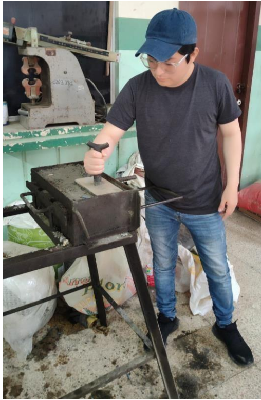
Foto 39. Compactación de la mezcla para bloque. Elaborado por: Lara, R. y Mejía, N. (2022)
