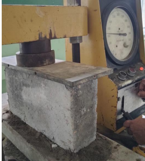
Foto 49: Ensayo a compresión Elaborado por: Lara, R. y Mejía, N. (2022)
