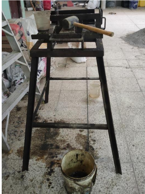
Foto 32. Colocación de aceite a molde para bloque. Elaborado por: Lara, R. y Mejía, N. (2022)
