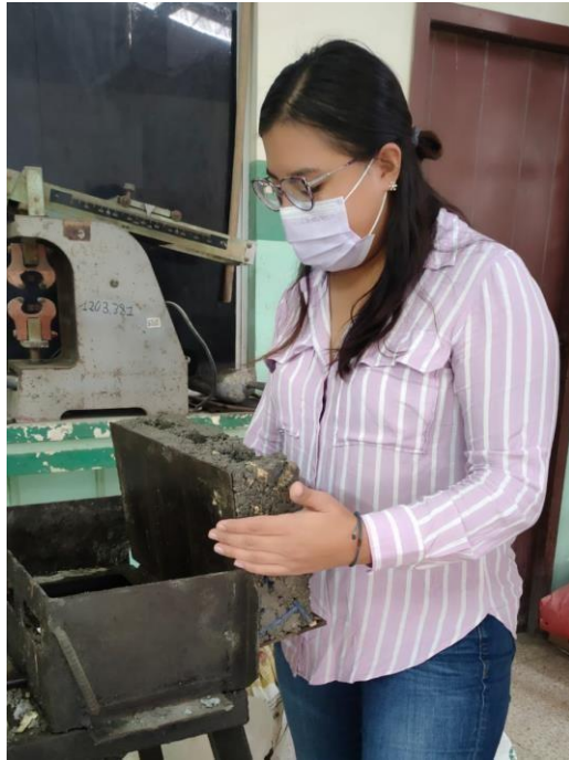
Foto 41: Retiro del bloque del molde. Elaborado por: Lara, R. y Mejía, N. (2022)
