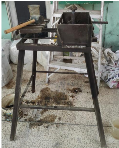
Foto 31: Preparación del molde para bloque. Elaborado por: Lara, R. y Mejía, N. (2022)
