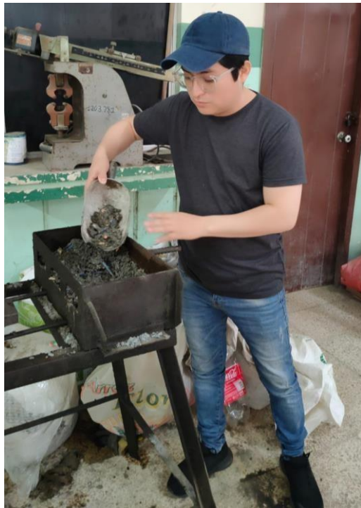
Foto 37. Colocando mezcla al molde. Elaborado por: Lara, R. y Mejía, N. (2022)
