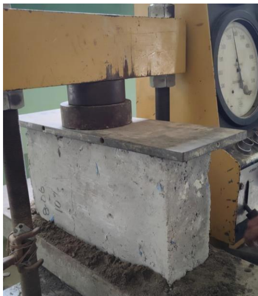
Foto 50: Ensayo a compresión Elaborado por: Lara, R. y Mejía, N. (2022)
