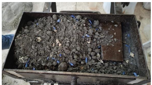
Foto 38. Relleno de los bloques. Elaborado por: Lara, R. y Mejía, N. (2022)
