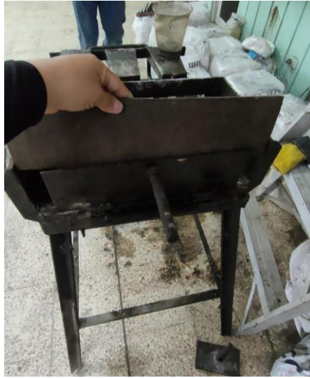
Foto 30: Preparación del molde para bloque. Elaborado por: Lara, R. y Mejía, N. (2022)
