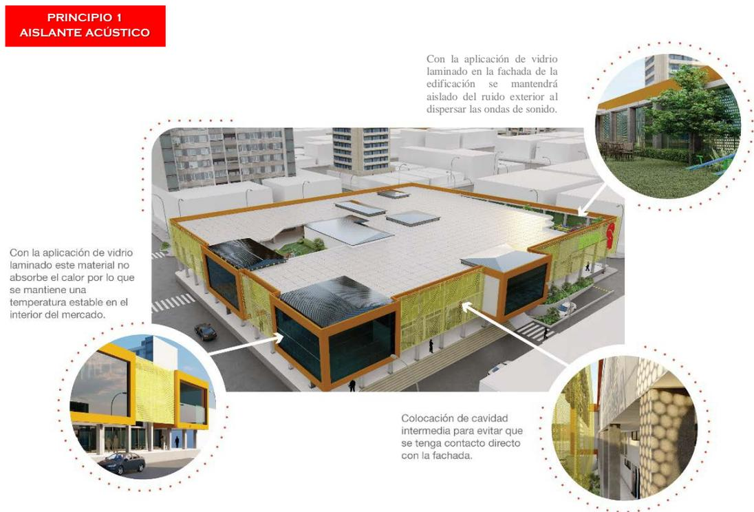
**Figura 50: Principio 1- Aislante Acústico**
