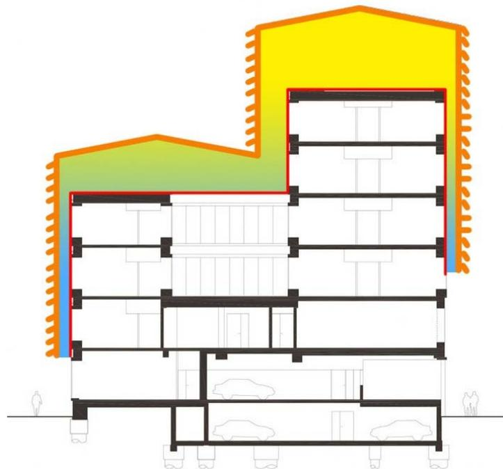
*Figura 9: Explicación del sistema doble piel en corte.*
