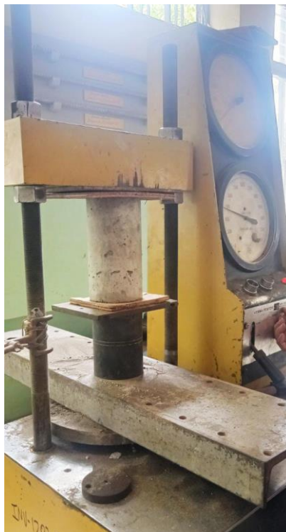
Figura 27. Ensayo a la compresión.
