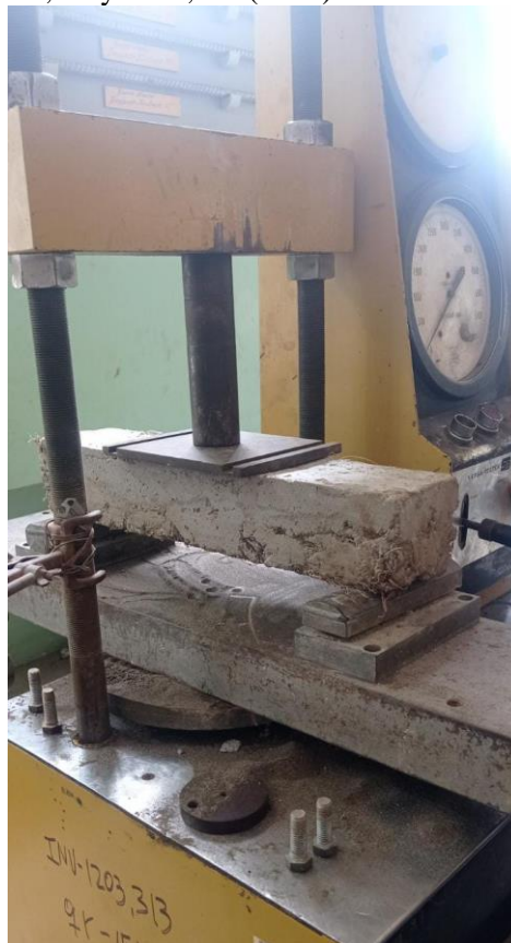
Figura 28. Ensayo a la flexión.
