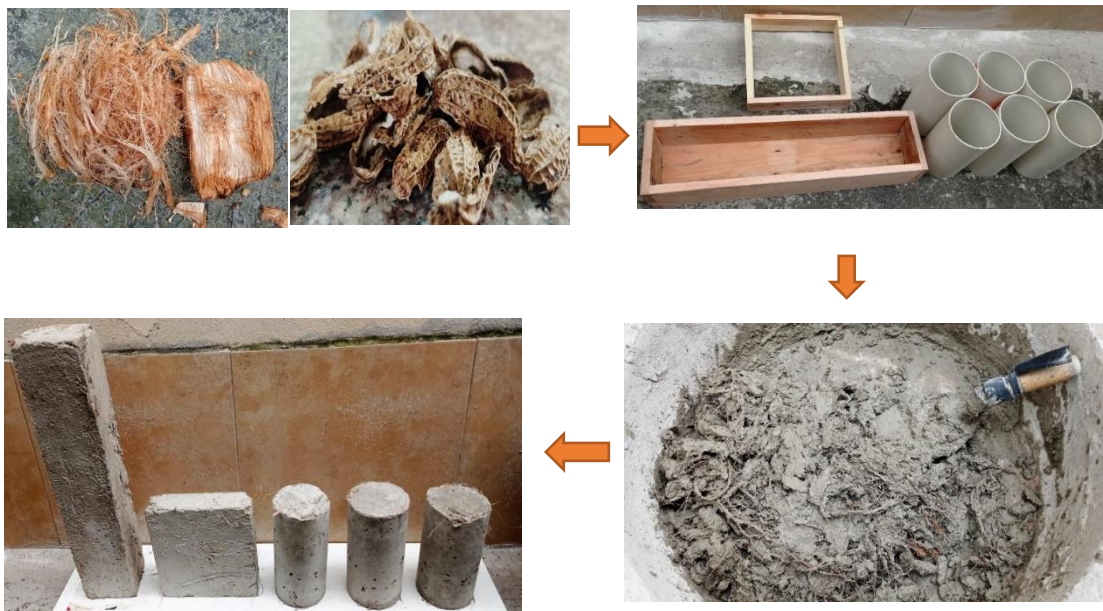
Figura 19. Flujograma de elaboración de prototipos. Elaborado por: Vásconez, A. y Viña, M. (2022)
