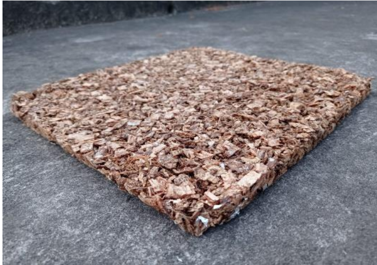
Figura 4. Panel de cáscara de maní y fibra de plátano. Elaborado por: Minaya, A. y Echeverría, E. (2021)
