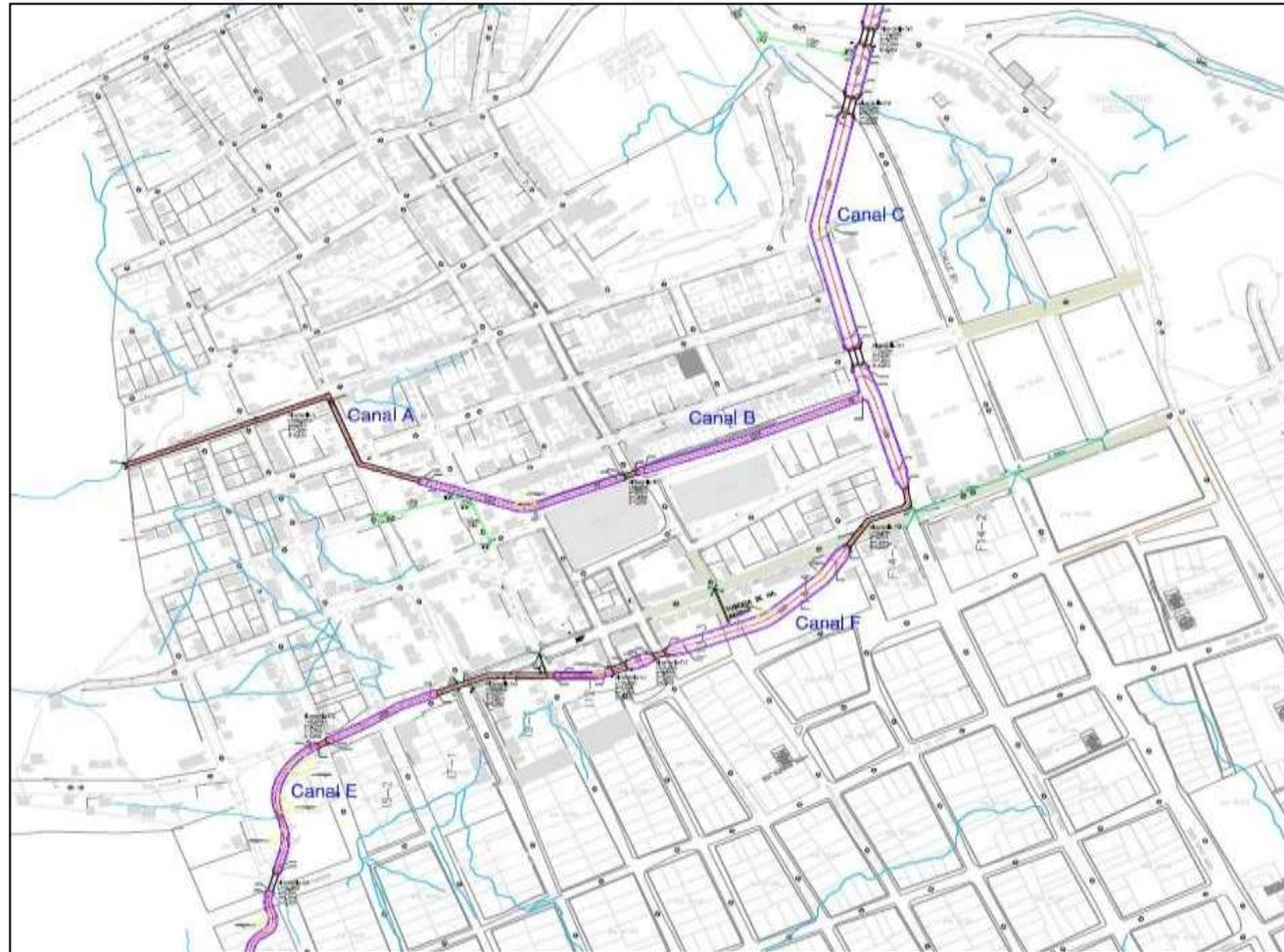
Figura 15. Sistema de drenaje de aguas lluvias propuesto
