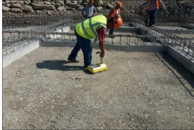
Figura 16. Prueba del densímetro nuclear Fuente: EMAPAG E.P.
