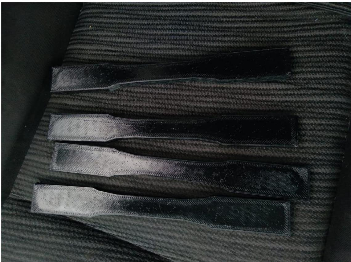
**Anexo 7:** Probetas numeradas para el respectivo ensayo de Tracción según normativa
