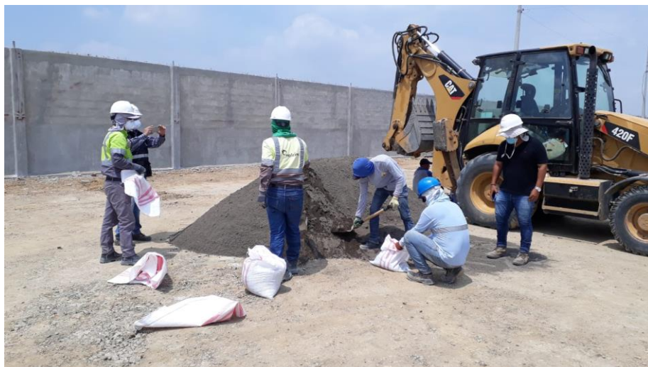
Imagen 43. Toma de muestras Elaborado por: Pozo, C. (2021)
