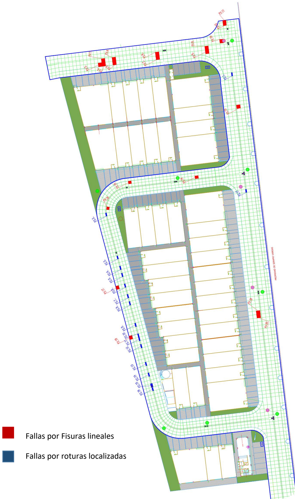
Imagen 60. Paños con defectos Elaborado por: Pozo, C. (2021)
