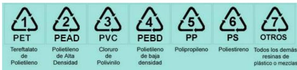
**Figura 5** Leyenda que identifica el material de fabricación productos plásticos
