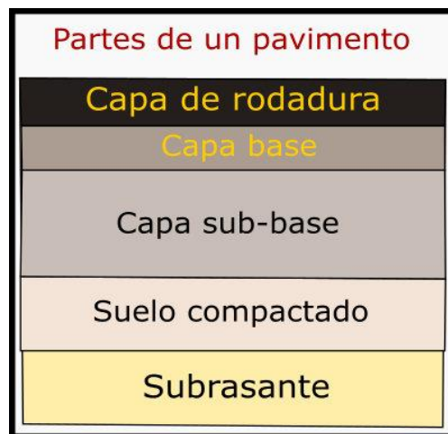
Figura 8. Partes de un pavimento
