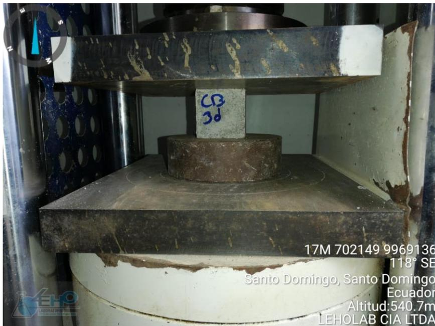
*Figura 24: Muestra de Mortero con cemento blanco a los 3 días en la máquina*
