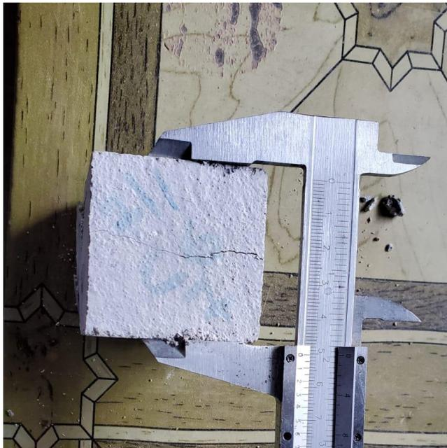
**Figura 19: Medición de cubos mediante vernier**
