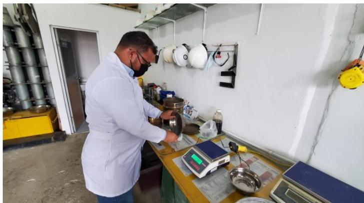
Figura 10: Recogiendo el agregado fino por tamiz
