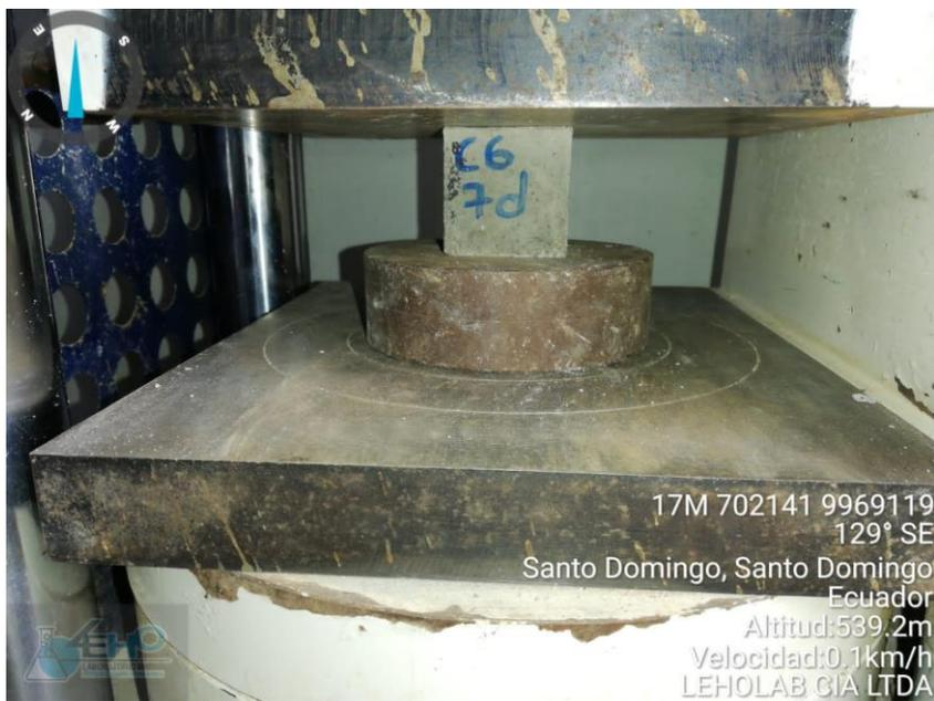
**Figura 21: Muestra de Mortero con cemento gris a los 7 días en la máquina**
