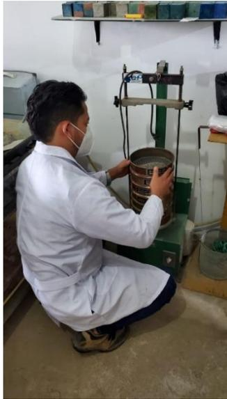
Figura 6: Figura 4.1 Ensayo de Granulometría
