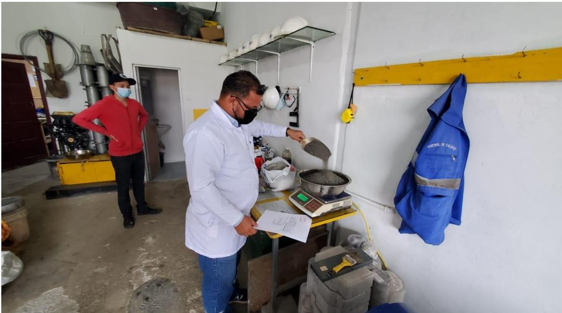
**Figura 9:** *Pesando el Agregado Fino*
