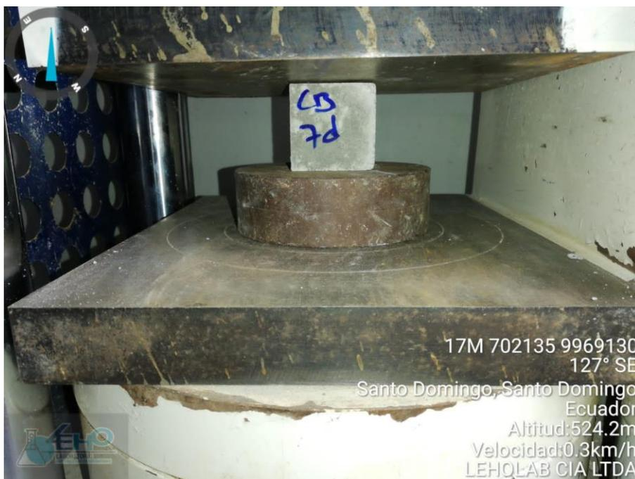
*Figura 25: Muestra de Mortero con cemento blanco a los 7 días en la máquina*
