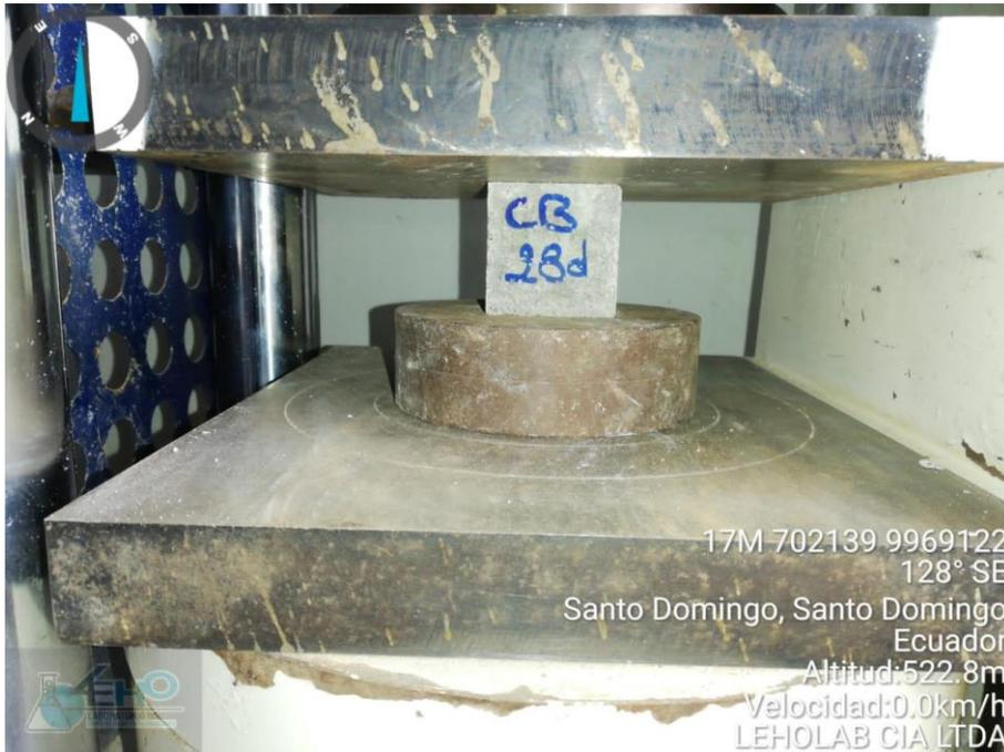
**Figura 26: Muestra de Mortero con cemento blanco a los 28 días en la máquina**
