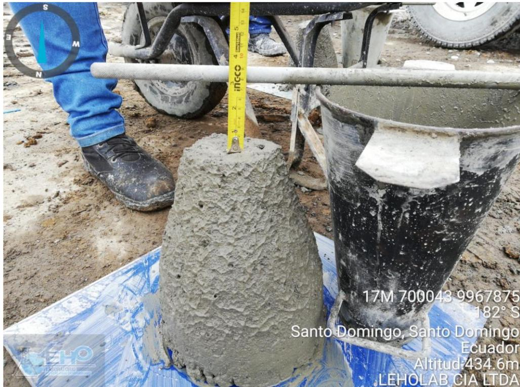
**Figura 15: Ensayo de Cono de Abrams CG**
