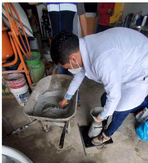
**Figura 13: Colocación del mortero con cemento gris al molde**
