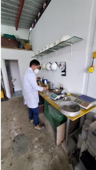
**Figura 11: Pesando el Agregado Fino por tamiz**
