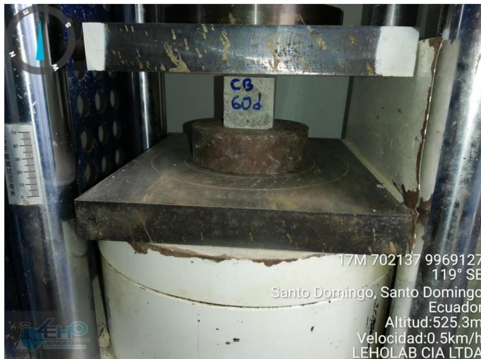
**Figura 27: Muestra de Mortero con cemento blanco a los 60 días en la máquina**
