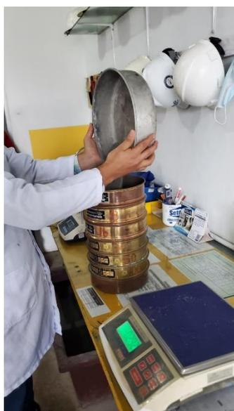
**Figura 5: Colocación del agregado fino a los tamices**
