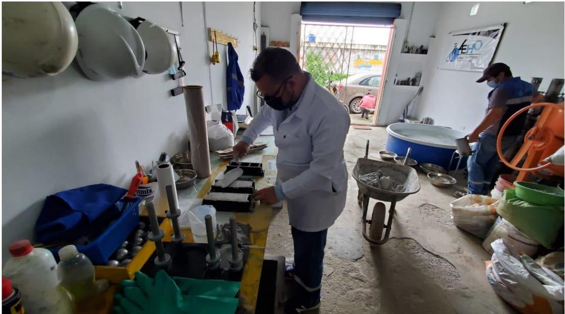
*Figura 17: Colocación del mortero en los moldes*
