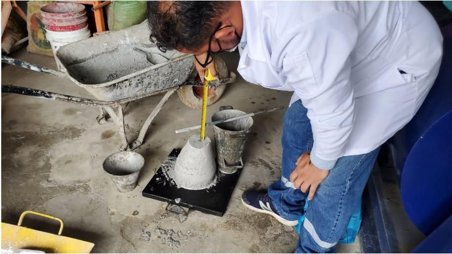
**Figura 14: Ensayo de Cono de Abrams CB**
