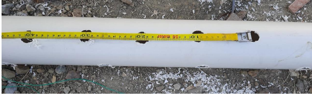
Figura 32. Distribuidores de caudal del humedal artificial
