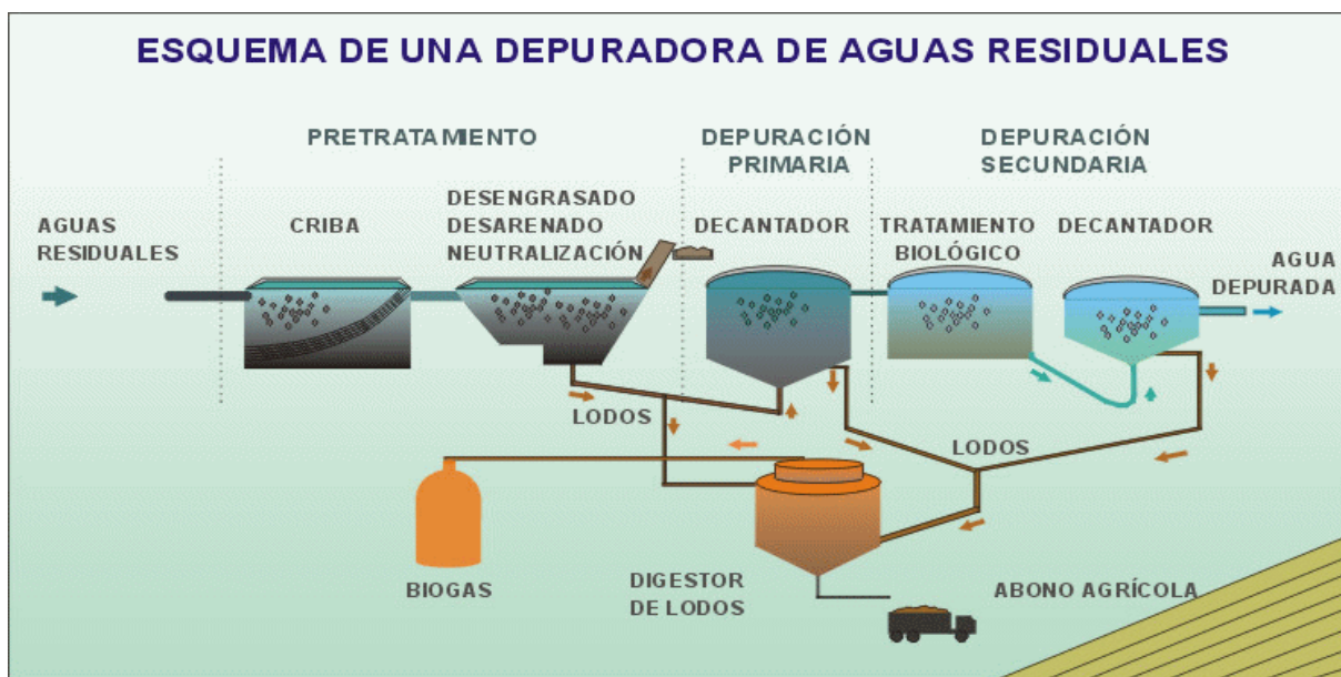
Figura 7 Esquema de una Depuradora de Aguas Residuales
