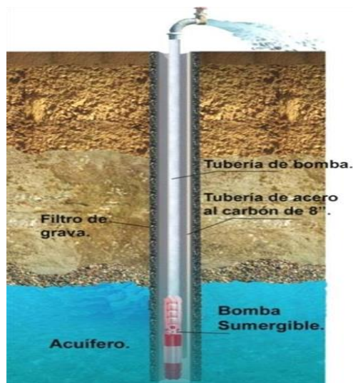
Figura 14 Pozo impulsado Fuente: (Gonzales, 2015)
