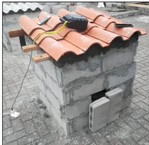
**Ilustración 29.** Ensayos realizados en prototipo con teja de arcilla
