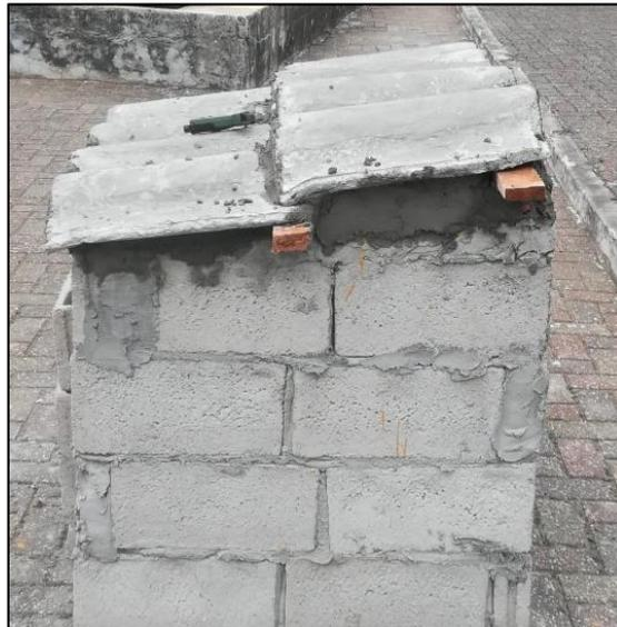
**Ilustración 31.** Ensayos realizados en prototipo con teja a base de arroz y PET
