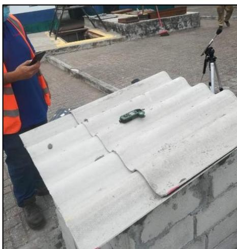
**Ilustración 28.** Ensayos realizados en prototipo con teja de fibro cemento
