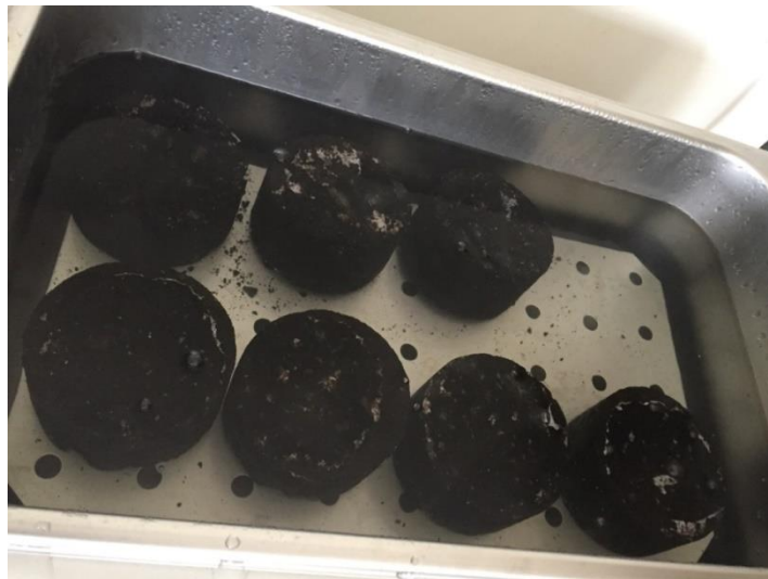
Ilustración 27 Baño maría de las briquetas, durante 40 minutos.
