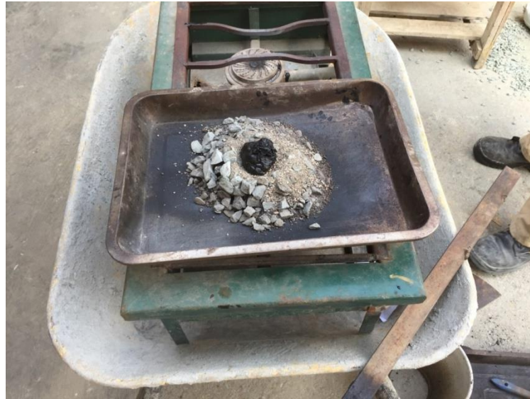
Ilustración 18 Colocación de los agregados y el cemento asfáltico
