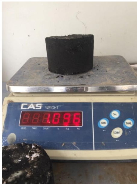
Ilustración 23 Peso de las briquetas en seco
