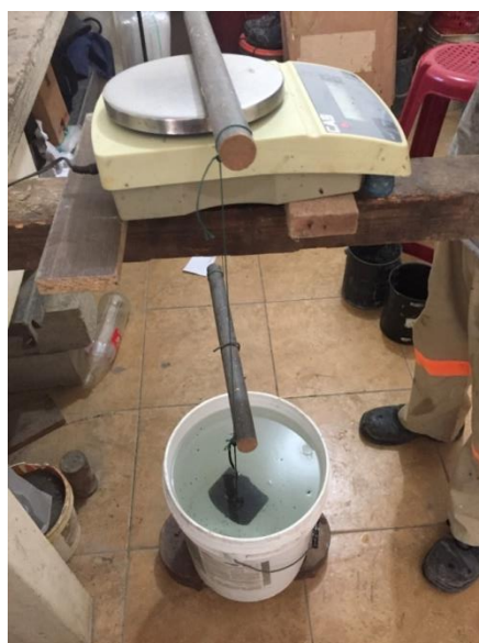
Ilustración 25 Peso de la briqueta en el agua
