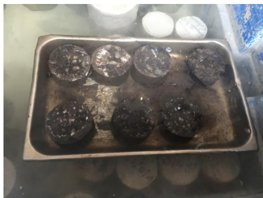
Ilustración 24 Briquetas sumergidas en el agua.
