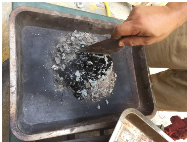
Ilustración 19 Mezcla de todos los agregados, junto con el cemento asfáltico.
