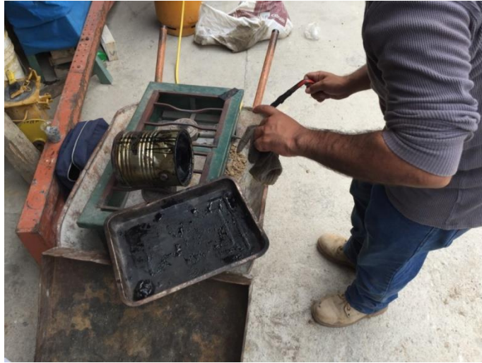
Ilustración 16 Calentamiento del cemento asfáltico para el previo análisis.
