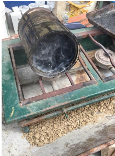
Ilustración 17 Calentamiento del cemento asfáltico para el previo análisis.
