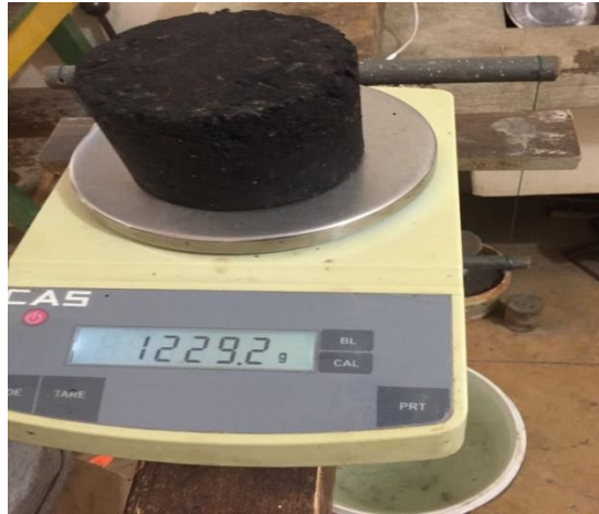
Ilustración 28 Lectura del peso de la briqueta luego de baño maría.
