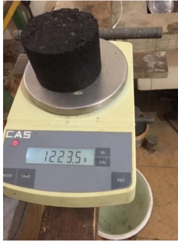
Ilustración 26 Lectura del peso de la briqueta en seco.
