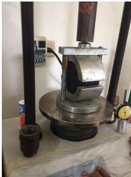
Ilustración 29 Dispositivo utilizado para realizar las pruebas de estabilidad.
