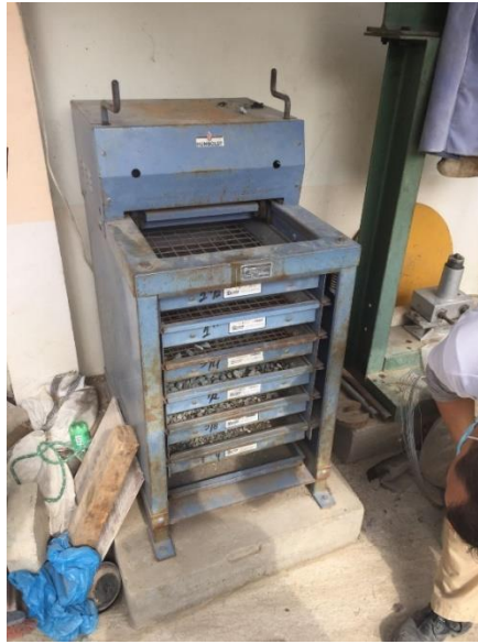
Ilustración 14 Clasificación de los agregados en función de los tamices según la normativa ASTM C 136
