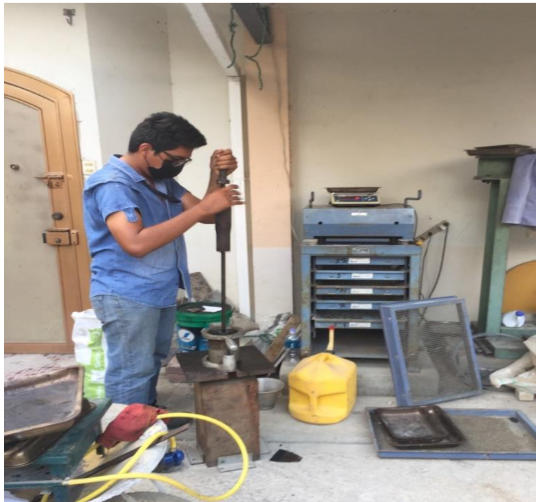
Ilustración 21 Compactación de la briqueta utilizando un martillo de 10 lb y a una altura de 18”.
