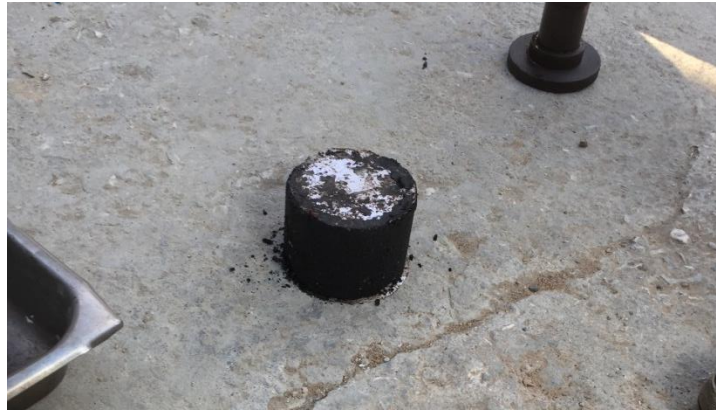
Ilustración 22 Resultado final de la compactación realizada.
