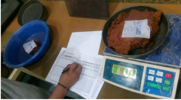
**Figura 39.** Pesado del Prototipo fuera del horno
