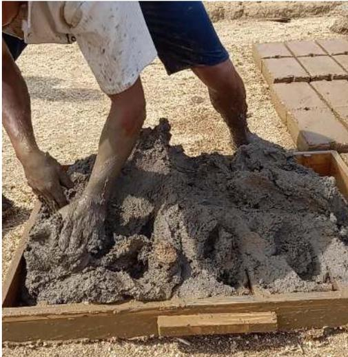
**Figura 29.** Deposito Mezcla de materiales en molde
