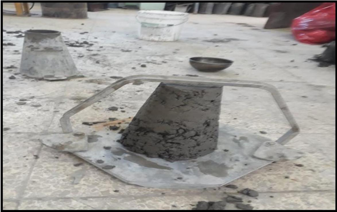
**Ilustración 51:** Prueba de cono de Abrams a hormigón de resistencia de 350 kg/cm<sup>2</sup>
