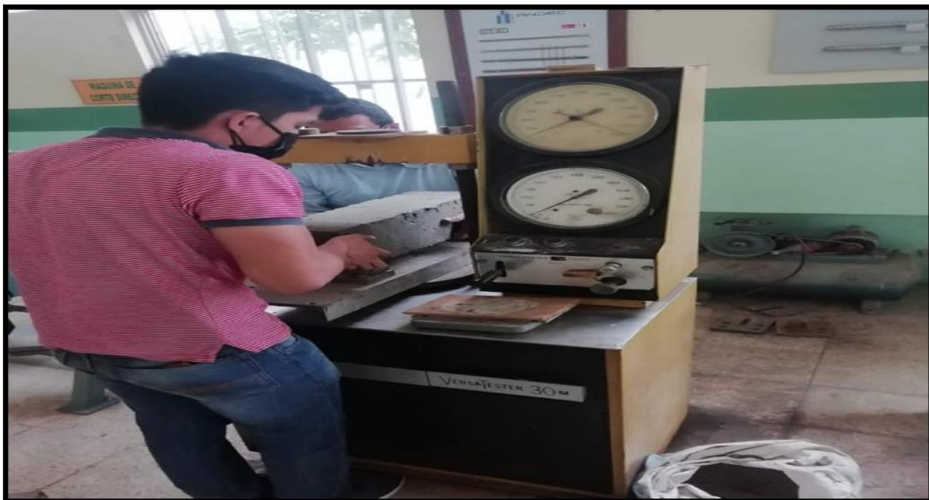
*Ilustración 71: Rotura de viga con el 10% de agregado reemplazado a los 28 días
