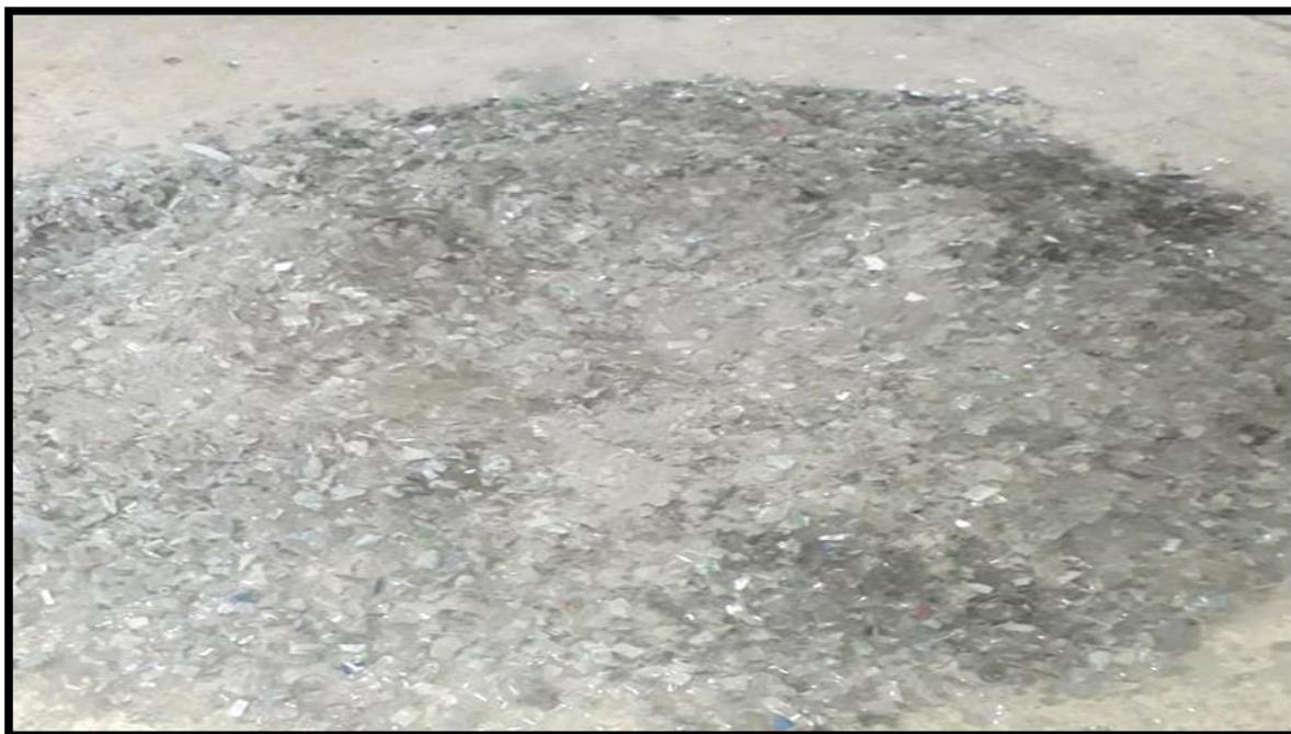
**Ilustración 30:** *Sustitución de la piedra y arena por el 15% fibras de Tereftalato de Polietileno (PET) y cenizas del bagazo de la caña de azúcar*
