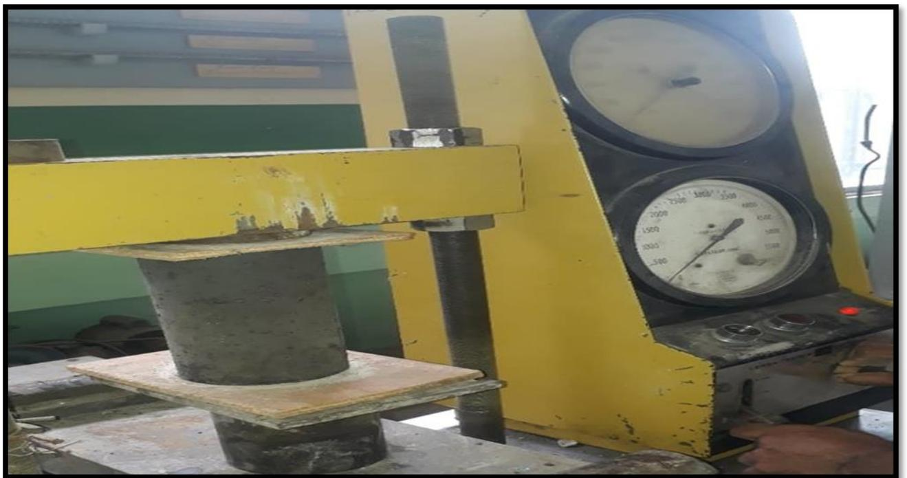
*Ilustración 58: Rotura de cilindro con el 10% de agregado reemplazado a los 7 días
