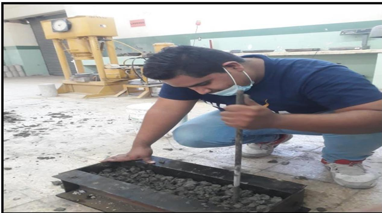
*Ilustración 39: Vaciado de primera capa para cilindro y viga con el 10% de agregado reemplazado
