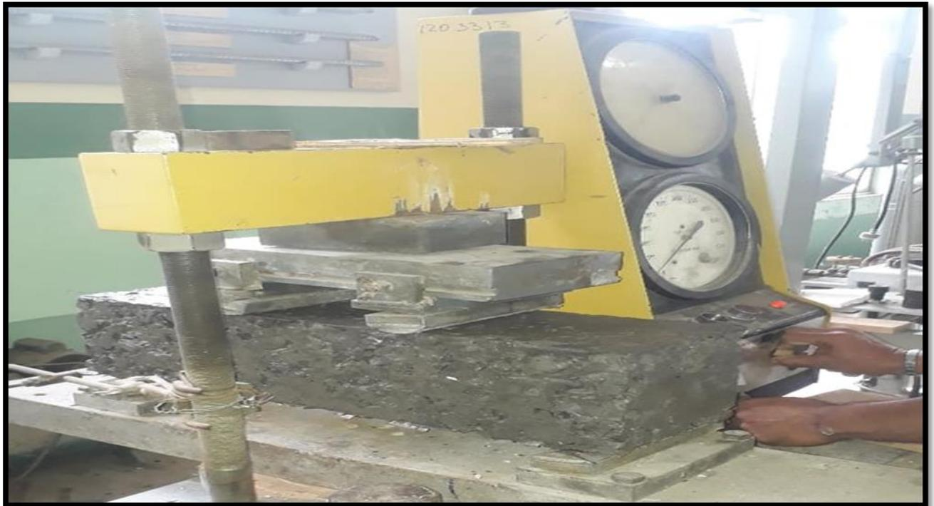
*Ilustración 65: Rotura de viga con el 10% de agregado reemplazado a los 14 días
