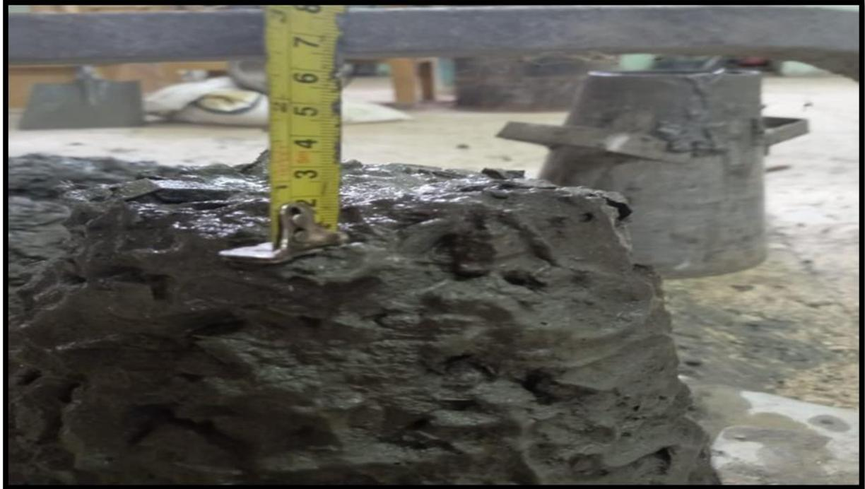
*Ilustración 54: Prueba de cono de Abrams con 15% de agregados reemplazados
