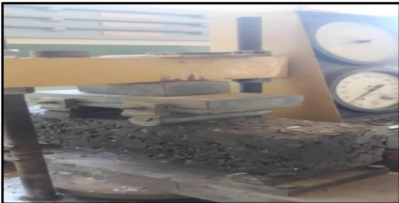
*Ilustración 73: Rotura de viga con el 15% de agregado reemplazado a los 28 días
