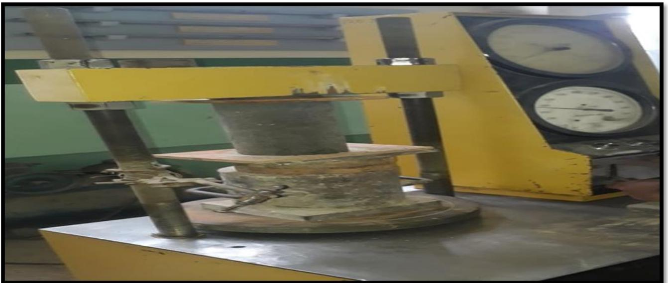
*Ilustración 56: Rotura de cilindro con el 5% de agregado reemplazado a los 7 días*
