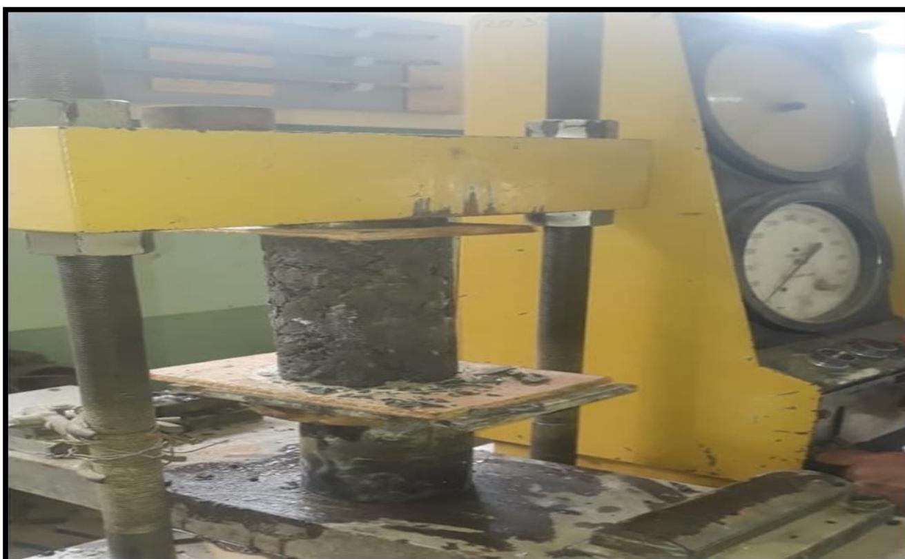
*Ilustración 60: Rotura de cilindro con el 15% de agregado reemplazado a los 7 días
