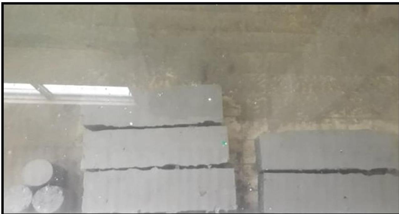
*Ilustración 48: Curado de las muestras del 5% de agregado reemplazado*
