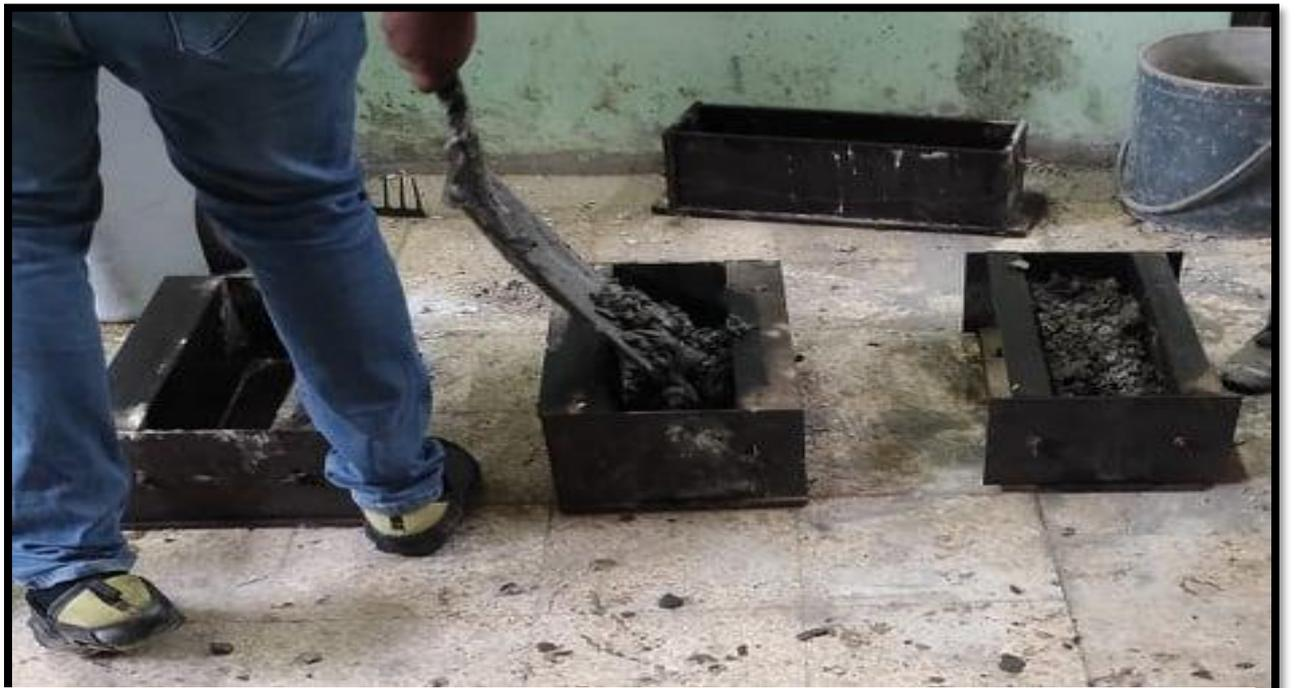
*Ilustración 43: Vaciado de segunda capa para vigas con el 15% de los agregados reemplazados
