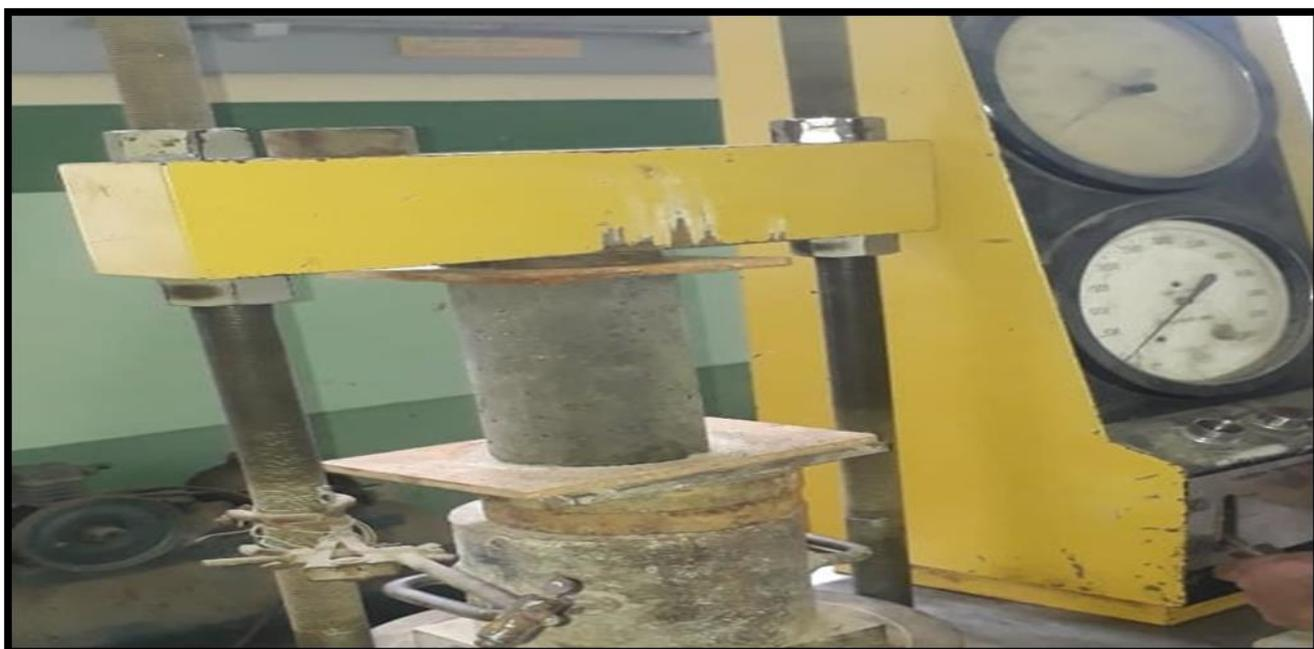
*Ilustración 68: Rotura de cilindro con el 5% de agregado reemplazado a los 28 días
