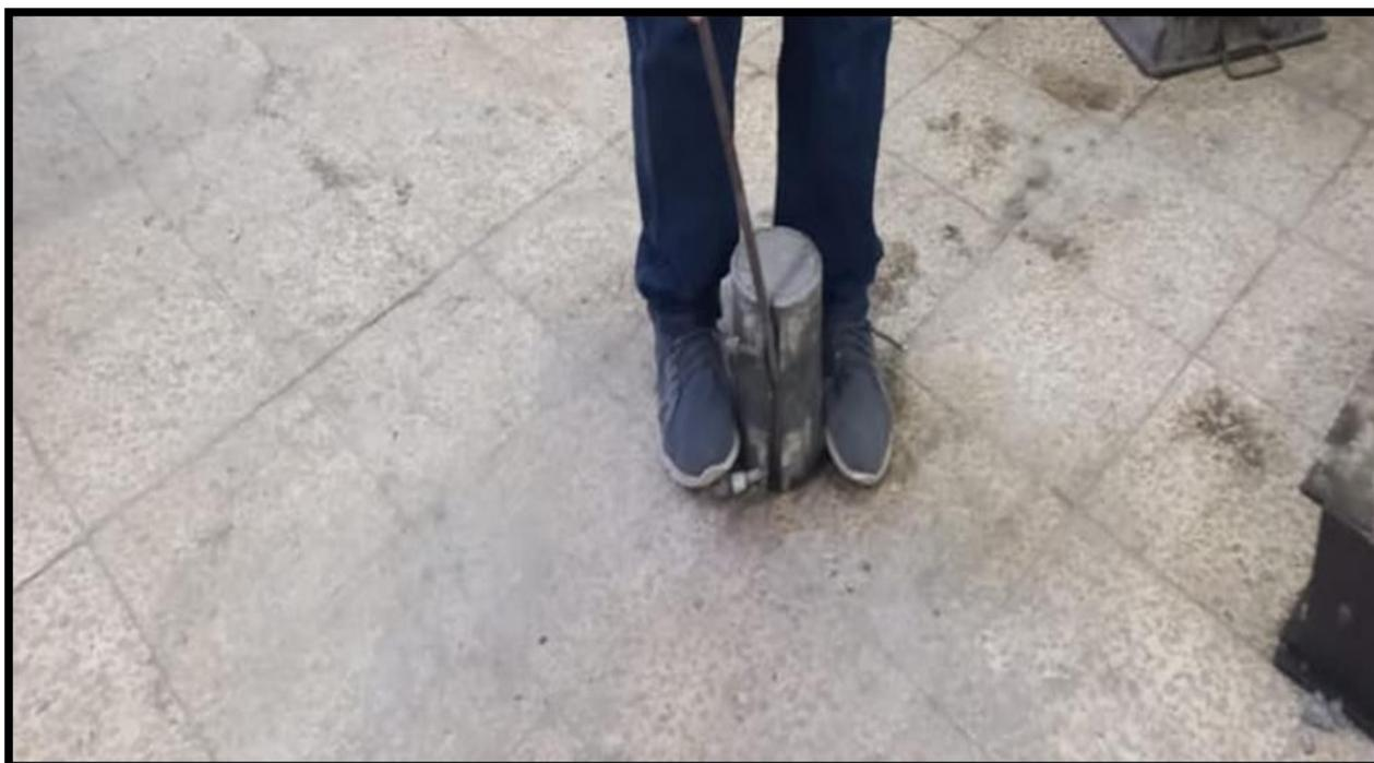
*Ilustración 46: Proceso para desmoldar cilindro*
