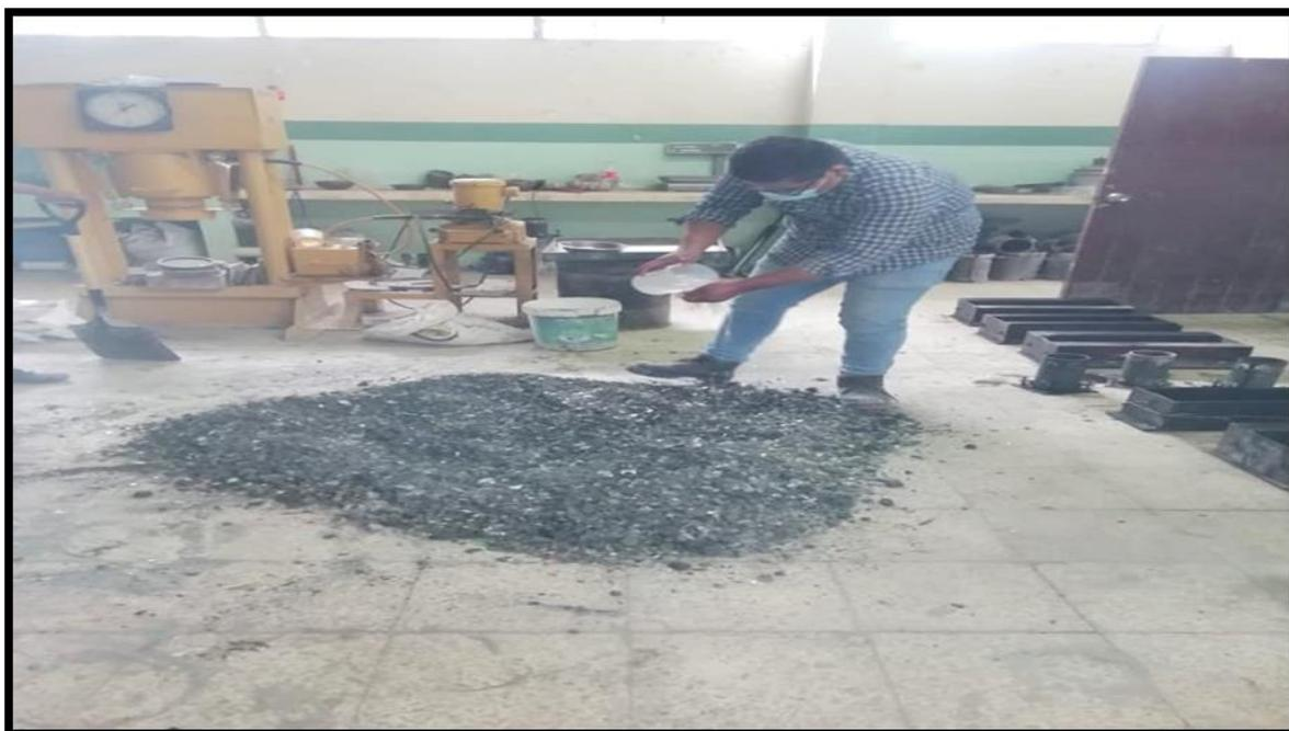
*Ilustración 33: Agregar agua a la mezcla donde se reemplaza el 15% de los agregados por el (PET) y Cenizas del bagazo de caña de azúcar*
