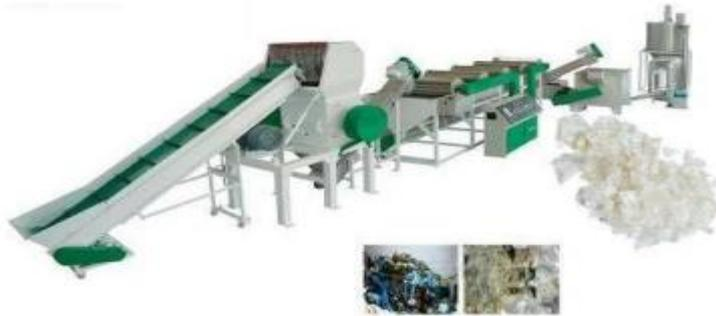
*Ilustración 15: Máquina de molido, lavado y secado*
