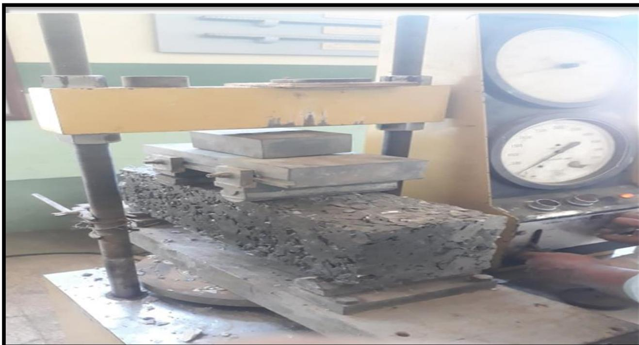
*Ilustración 69: Rotura de viga con el 5% de agregado reemplazado a los 28 días
