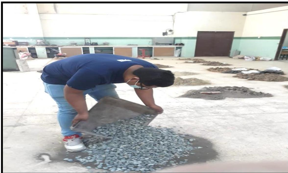
**Ilustración 19:** Cama de piedra para la elaboración de hormigón de 350 kg/cm<sup>2</sup>
