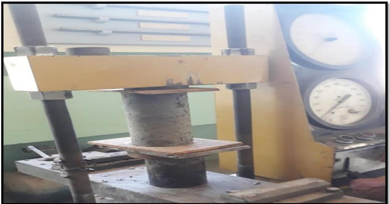
*Ilustración 66: Rotura de cilindro con el 15% de agregado reemplazado a los 14 días
