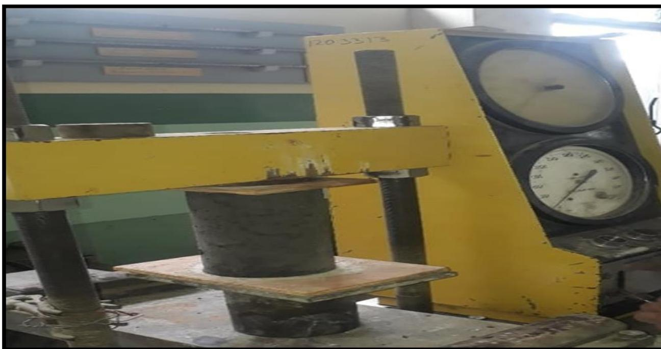
*Ilustración 64: Rotura de cilindro con el 10% de agregado reemplazado a los 14 días
