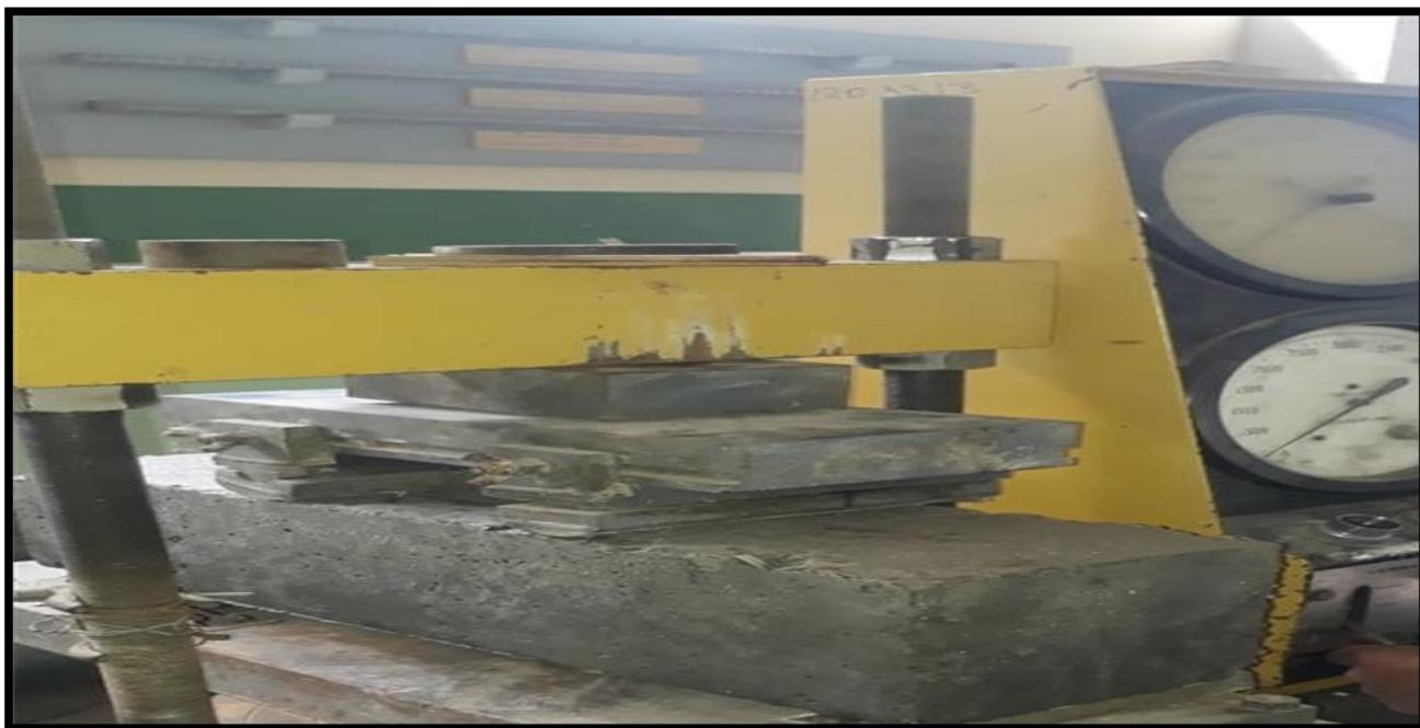
*Ilustración 63: Rotura de viga con el 5% de agregado reemplazado a los 14 días
