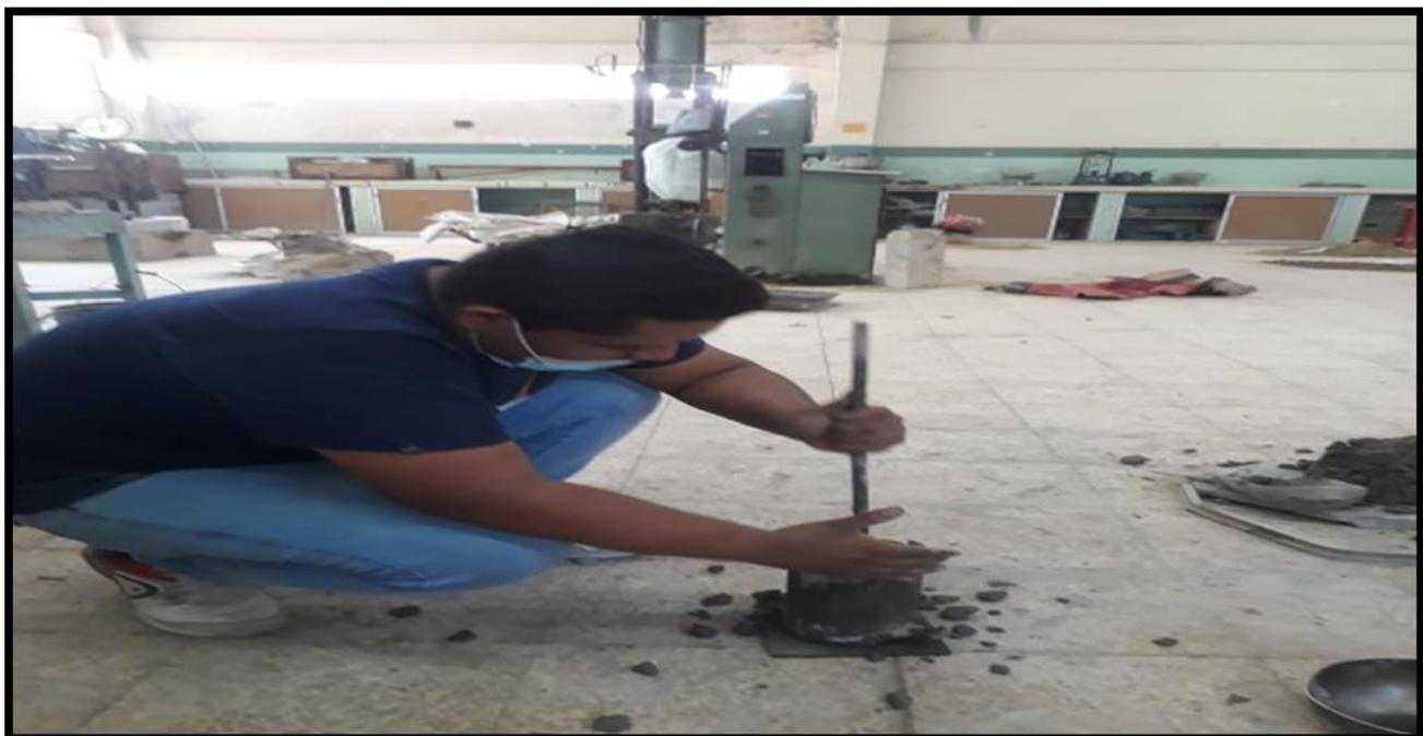
*Ilustración 40: Vaciado de segunda capa para cilindros y vigas con el 10% de agregado reemplazado
