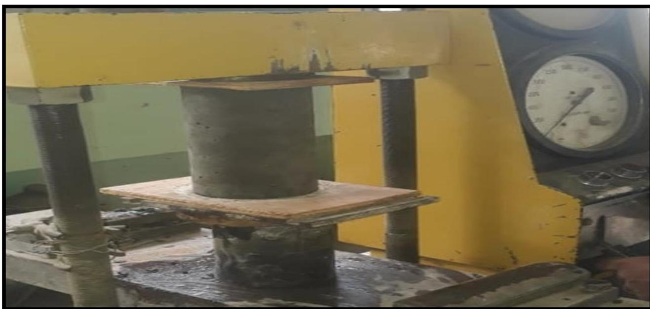
*Ilustración 62: Rotura de cilindro con el 5% de agregado reemplazado a los 14 días
