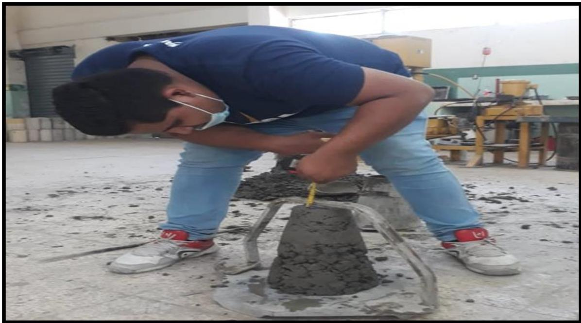
*Ilustración 53: Prueba de cono de Abrams con 10% de agregados reemplazados
