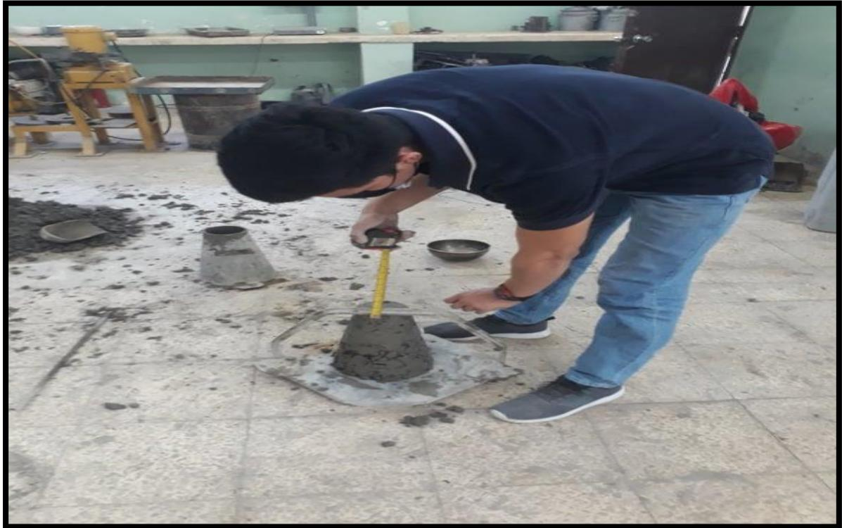
*Ilustración 52: Prueba de cono de Abrams con 5% de agregados reemplazados
