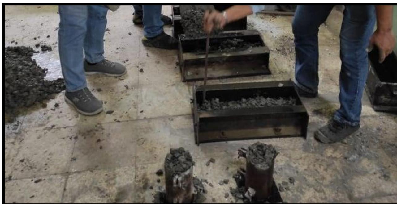
*Ilustración 37: Vaciado de segunda capa de cilindro y viga con el 5% de agregados reemplazados
