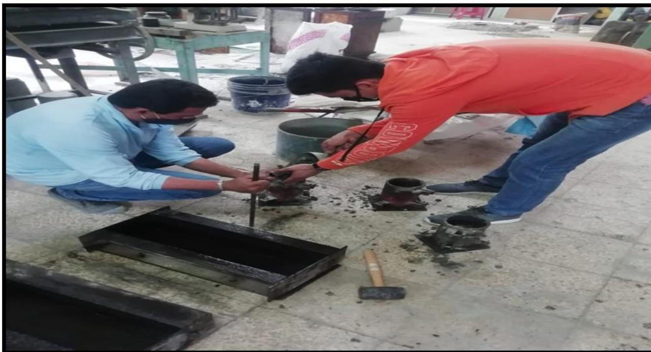
*Ilustración 36: Vaciado de primera capa de cilindro y viga con el 5% de agregados reemplazados
