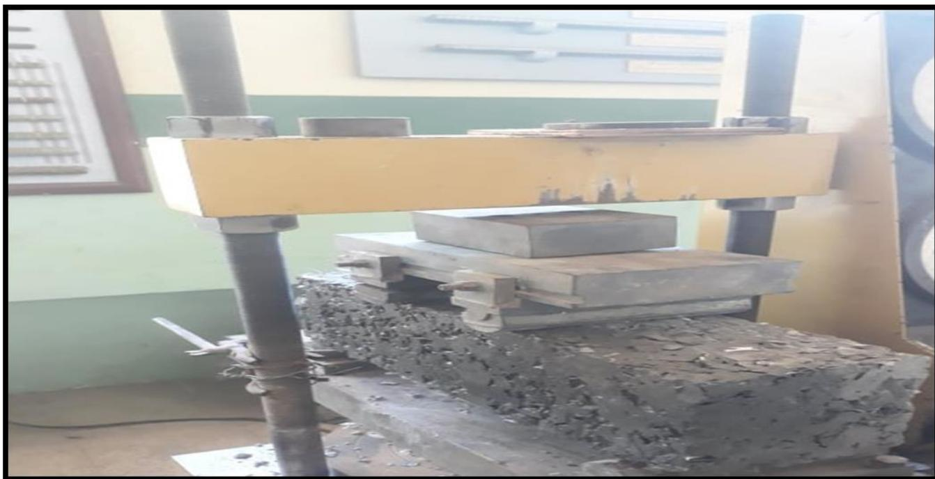
*Ilustración 67: Rotura de viga con el 15% de agregado reemplazado a los 14 días
