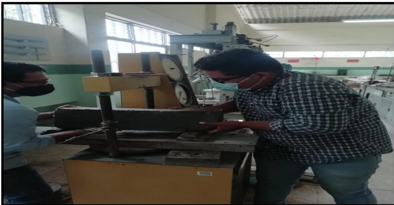
*Ilustración 59: Rotura de viga con el 10% de agregado reemplazado a los 7 días
