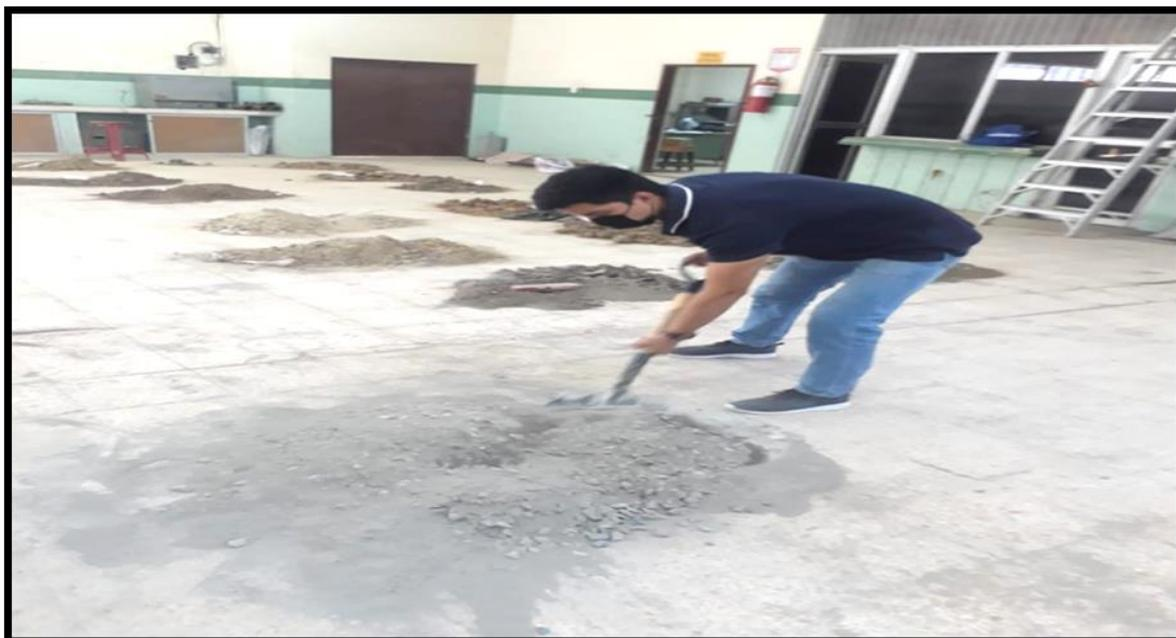
**Ilustración 28:** *Sustitución de la piedra y arena por el 5% fibras de Tereftalato de Polietileno (PET) y cenizas del bagazo de la caña de azúcar*
