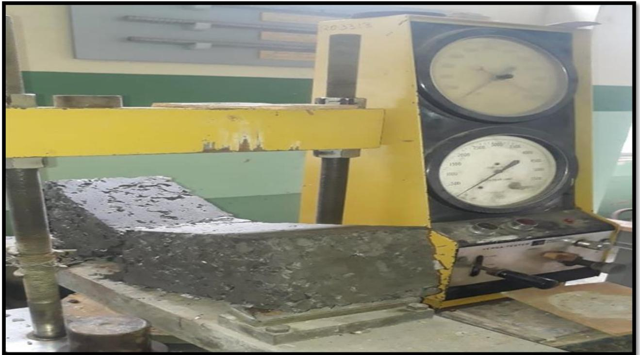
*Ilustración 57: Rotura de viga con el 5% de agregado reemplazado a los 7 días
