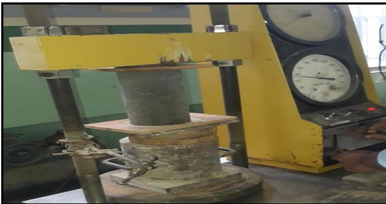
*Ilustración 70: Rotura de cilindro con el 10% de agregado reemplazado a los 28 días
