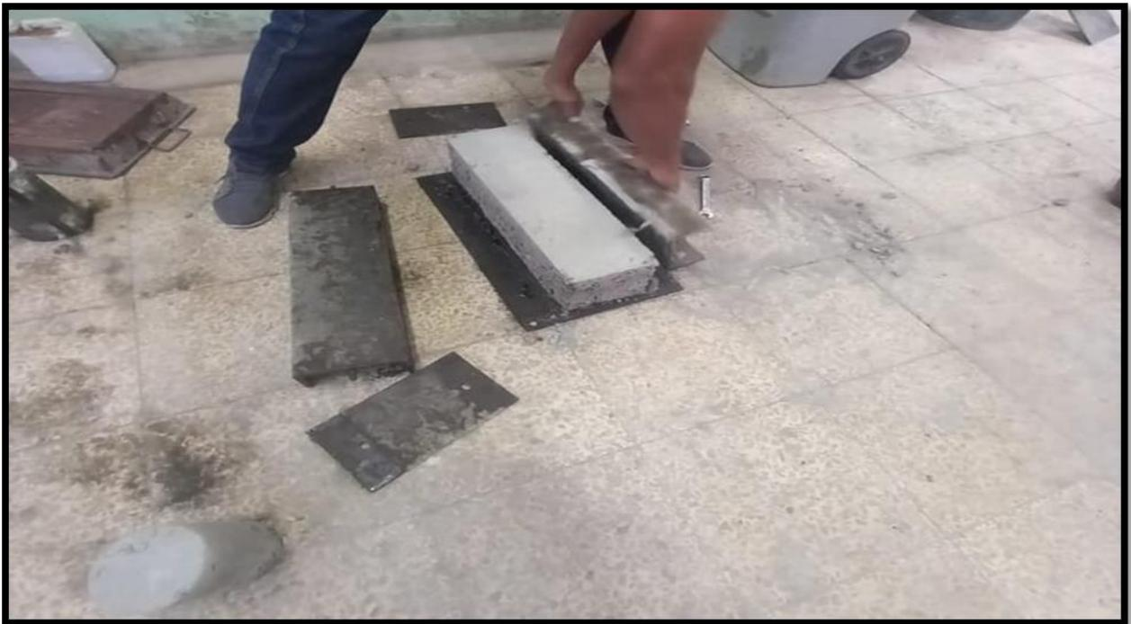
**Ilustración 44:** Proceso para desmoldar viga
