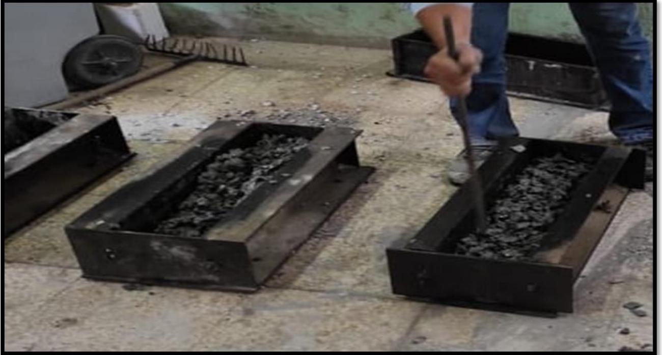
*Ilustración 42: Vaciado de primera capa para viga con el 15% de los agregados reemplazados
