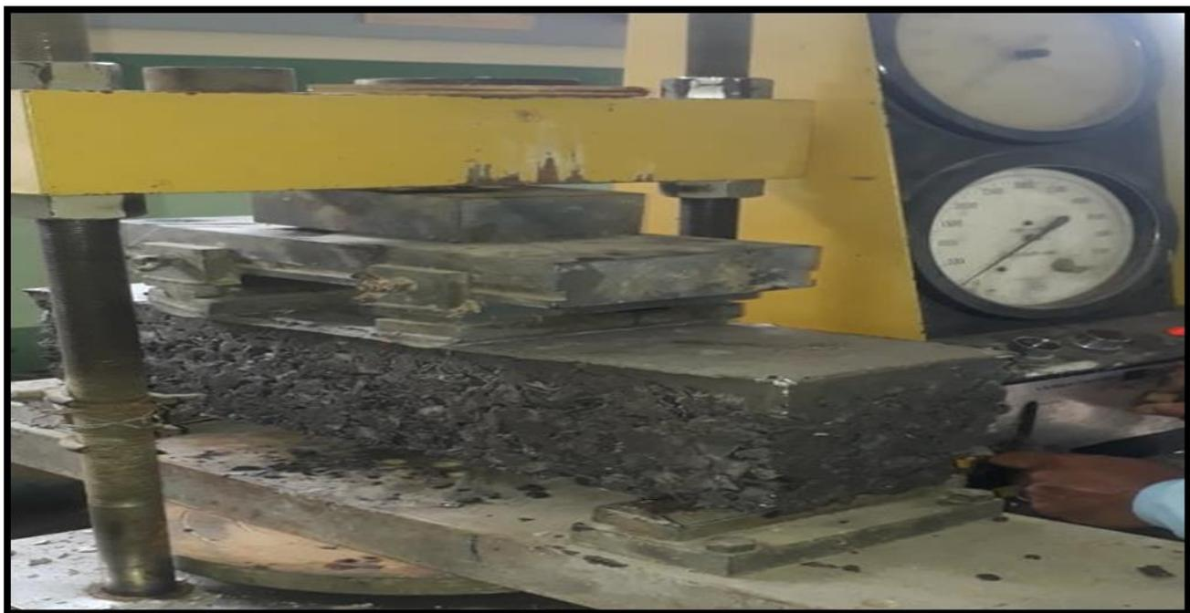
*Ilustración 61: Rotura de viga con el 15% de agregado reemplazado a los 7 días
