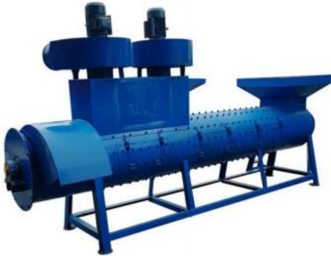
*Ilustración 13: Máquina removedor de etiqueta.*
