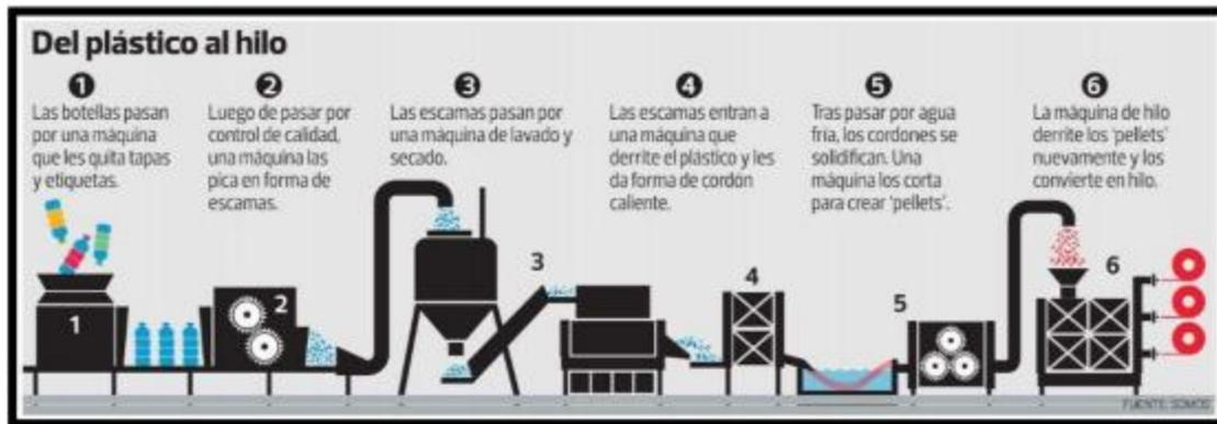
*Ilustración 11: Maquinarias para el reciclado de botellas*
