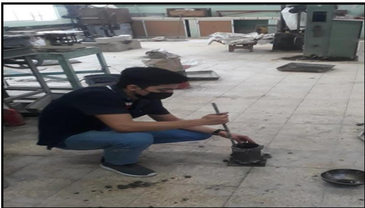
*Ilustración 41: Vaciado de primera capa para cilindro y viga con el 15% de agregado reemplazado
