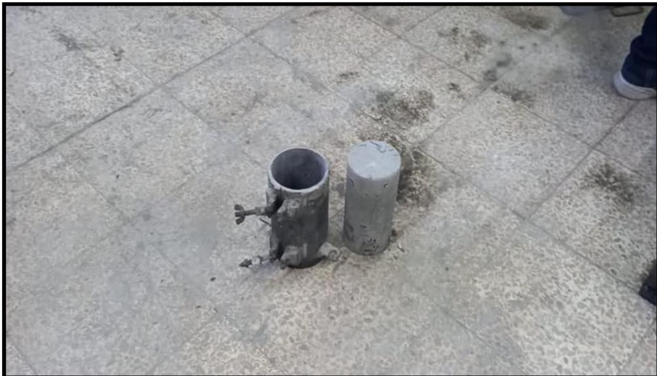
*Ilustración 47: Cilindro desmoldado*
