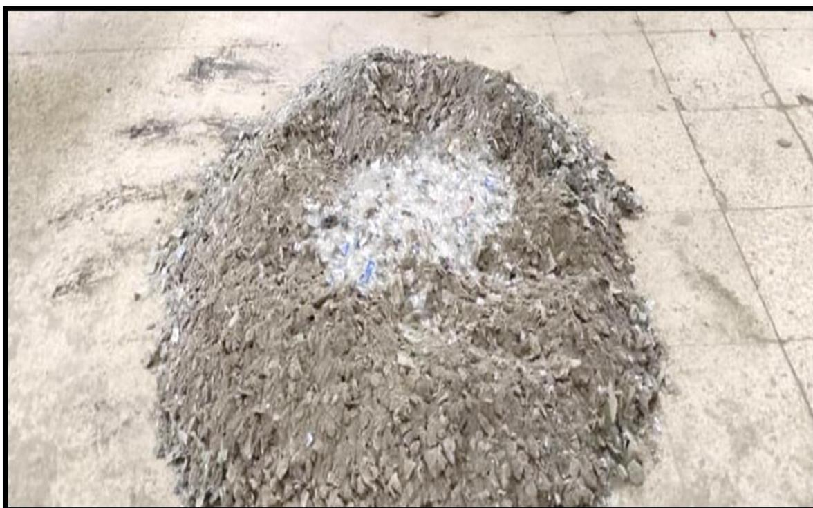
**Ilustración 29:** *Sustitución de la piedra y arena por el 10% fibras de Tereftalato de Polietileno (PET) y cenizas del bagazo de la caña de azúcar*
