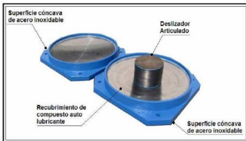
Figura 17. Características del Aislador bajo sistema de péndulo de fricción
