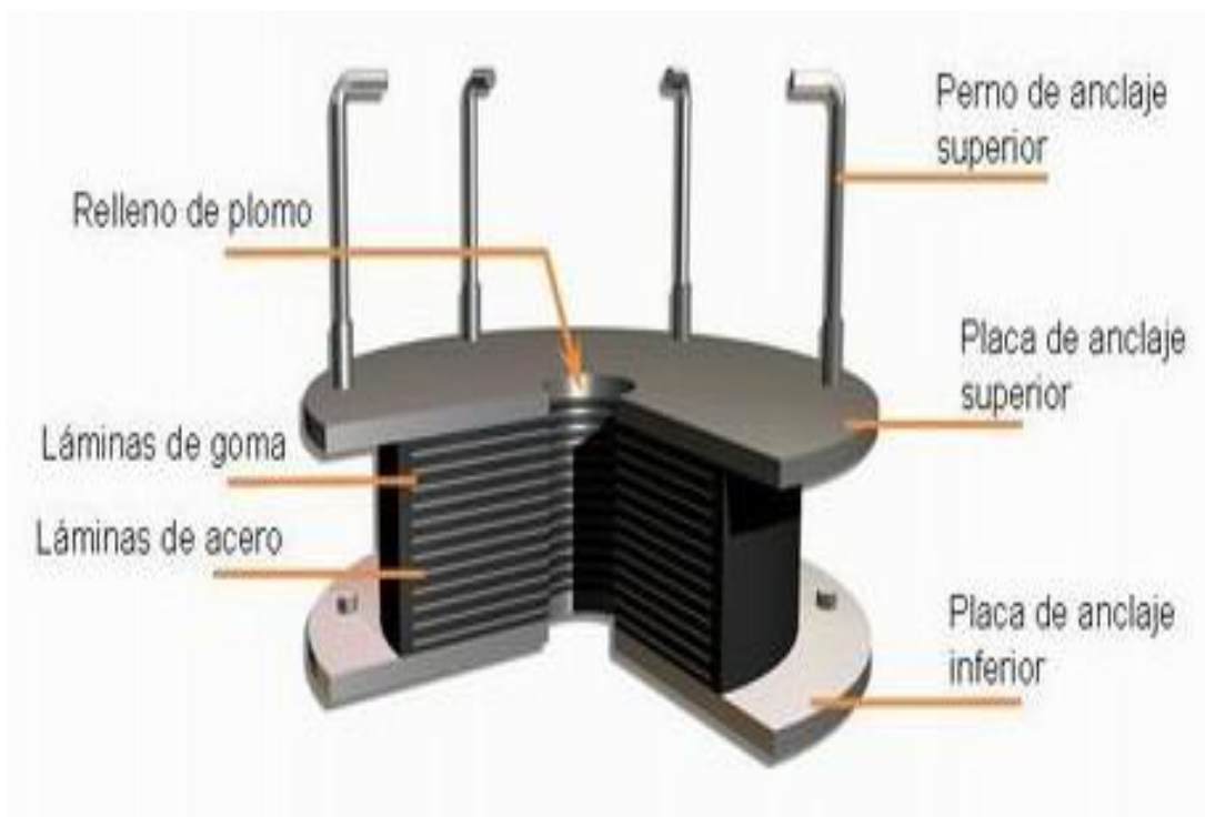
Figura 9. Formación del Aislador de alto amortiguamiento (HDR)
