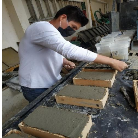
Figura 44: Fundición de adoquines sin capas.
