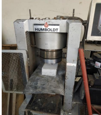
Figura 18: Máquina para los ensayos de compresión.
