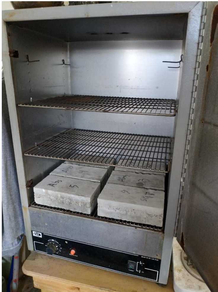
Figura 57: Colocación de los adoquines en horno.
