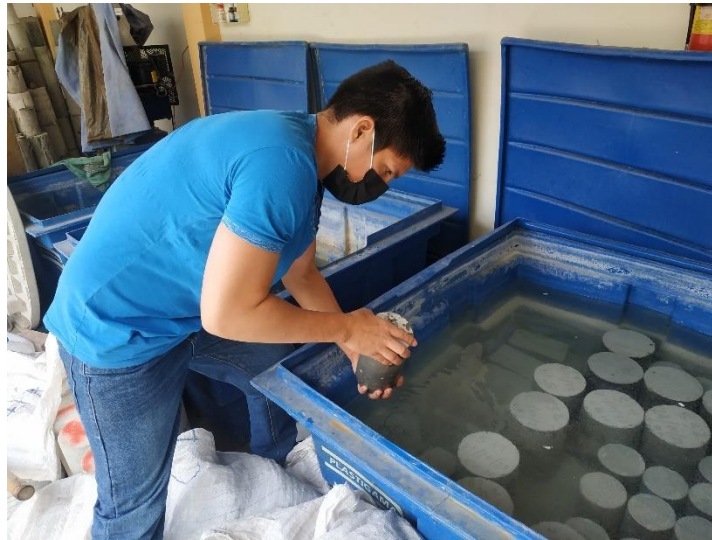
Figura 53: Colocación de adoquines y cilindros en piscinas de agua.
