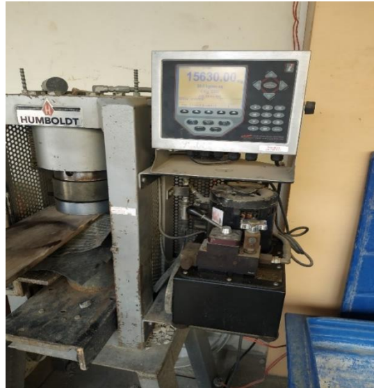
Figura 55: Ensayo de compresión de los adoquines.
