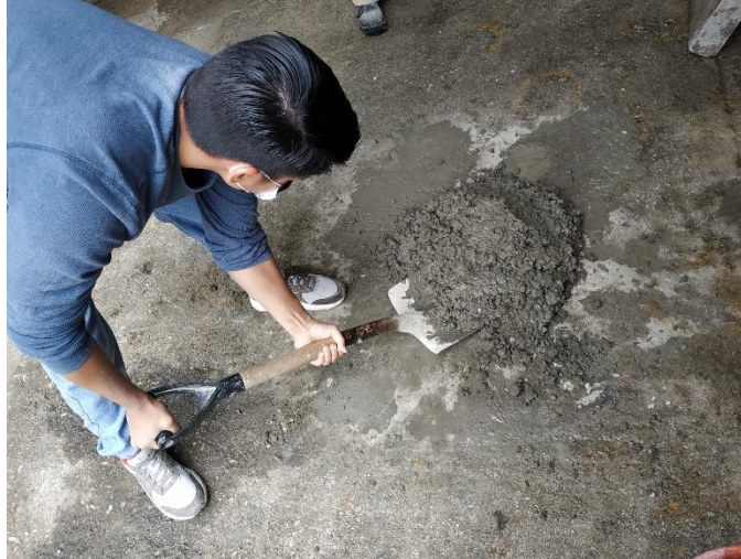
Figura 45: Realizando la mezcla de los cilindros.
