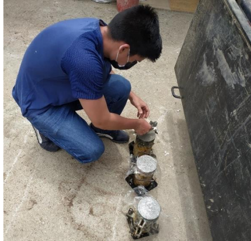
Figura 51: Desmoldado de cilindros.
