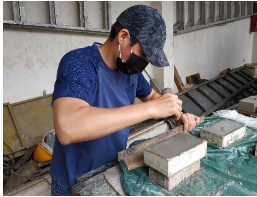
Figura 49: Desmoldado de los adoquines.
