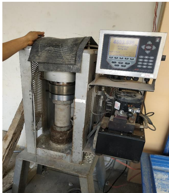
Figura 56: Ensayo de compresión de los cilindros.
