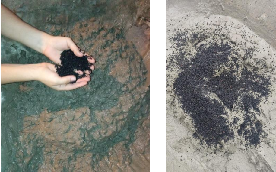
Figura 21: Mezcla del Hormigón con adiciones de fibras de acero y caucho reciclado.
