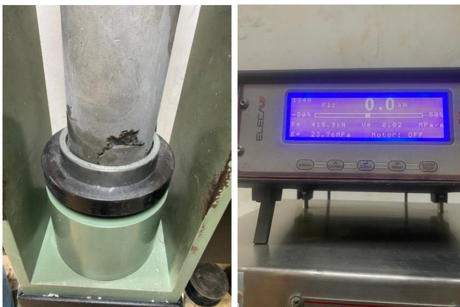
Figura 27: Rotura de Cilindros.
