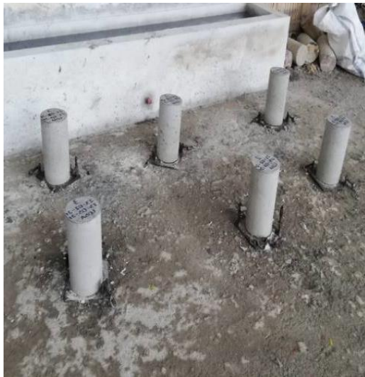
Figura 26: Desencofrado de Cilindros, identificación, fecha del muestreo.
