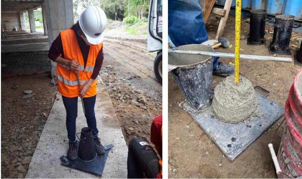
Figura 22: Ensayo del cono de Abrams para mezcla de hormigón tradicional
