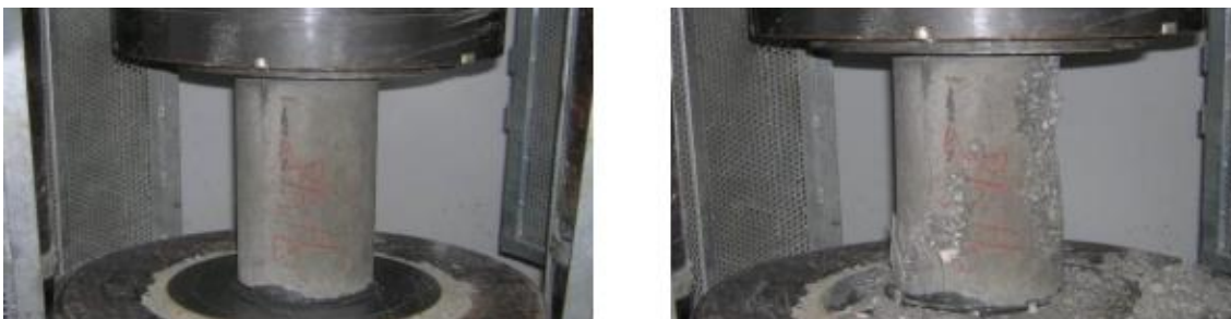
Figura 9. Rotura de la probeta. Se muestra la probeta antes y después de romper
