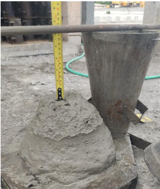
Figura 23: Ensayo del cono de Abrams para mezclas con caucho reciclado y fibra
