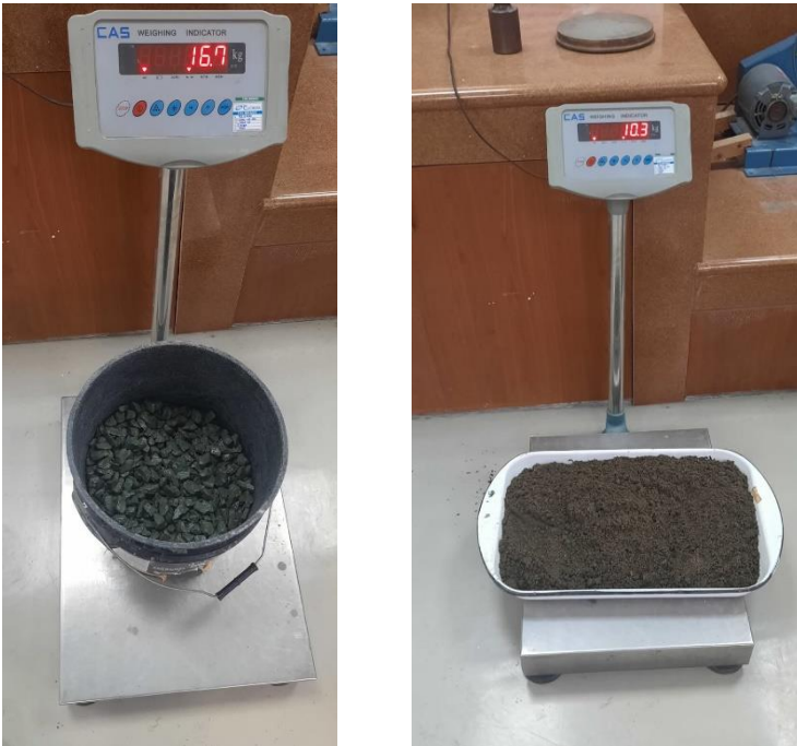
Figura 15: Piedra y arena empleados en la mezcla de hormigón
