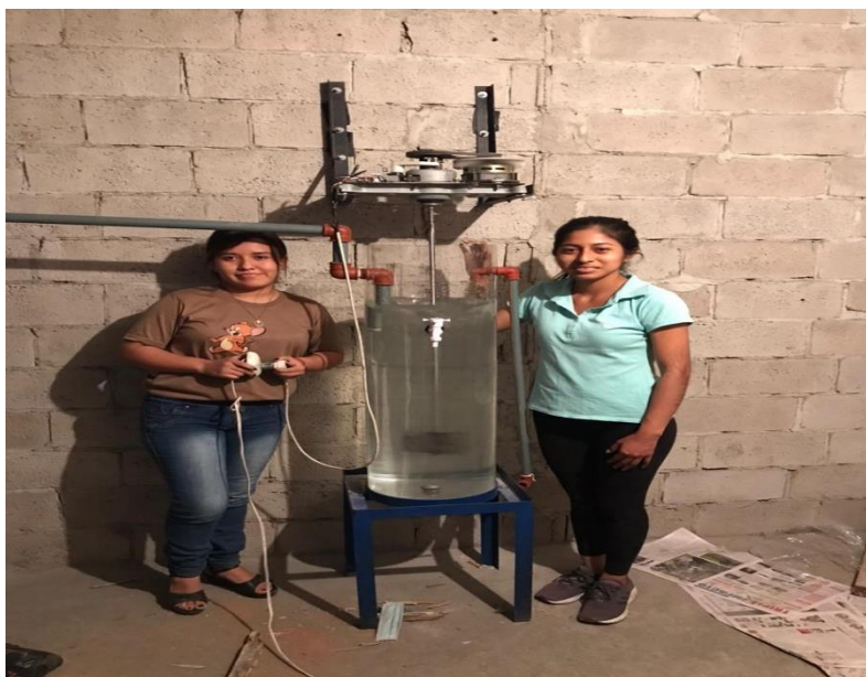
Ilustración 16: Prueba del reactor
