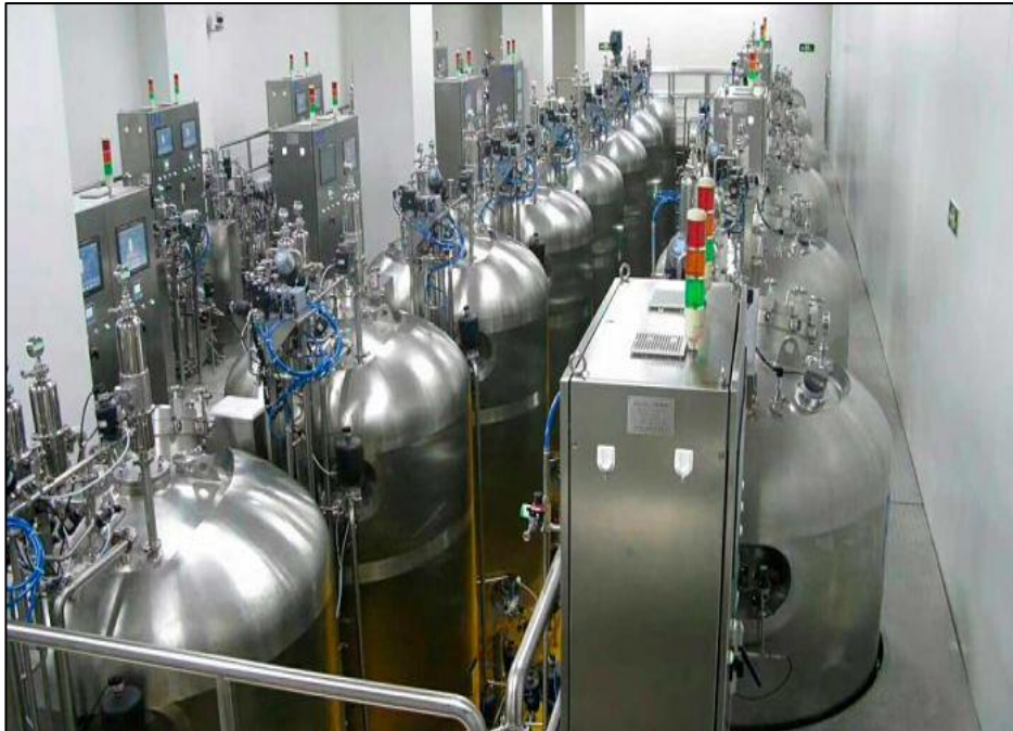
Figura 12 :Reactores de Mezcla Completa en Serie
