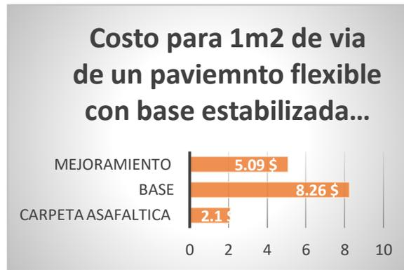
Figura 15 costos para un metro cuadrado de via de base estabilizada con cemento, Elaborado por: Bravo. A, (2022).
