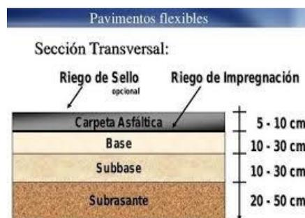
Figura 1 Estructura del Pavimento Flexible, fuente: Brando, E. (2017).
