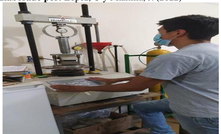
**Figura 15:** Prueba de compresión
